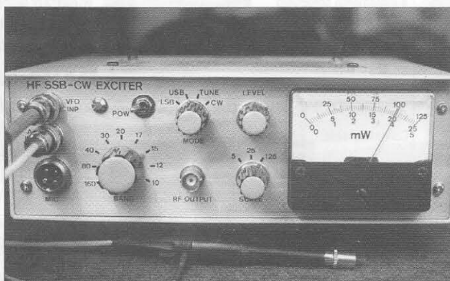
Vista frontal del Excitador Multibanda para SSB y CW. A la izquierda, las entradas de señal exterior VFO, AF y Micro/PTT. El instrumento, con escalas lineales de potencia, está señalando 100 mW de salida.
