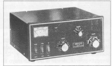
Foto A. Los amplificadores con válvulas de barrido de TV, como este AL-84 de Ameritron, utilizaban típicamente cuatro de esas válvulas en paralelo y en configuración de rejilla a masa, para obtener una potencia media-alta. Este tipo de amplificadores resultan bastante atractivos, dado que pueden funcionar conectados a una toma de corriente doméstica normal.
