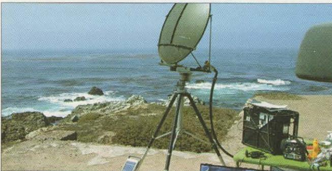
Foto E. Las actividades de microondas suponen, casi ineludiblemente, operar al aire libre. En la foto, la instalación de XE2/N6XQ y XE2ED durante un concurso en la Baja California (DM11). La parábola de 76 cm es una unidad de "surplus" y la caja de la derecha contiene un transversor DB6NT y un amplificador Qualcomm de 1 W. (Foto cortesía de la SBMS)
