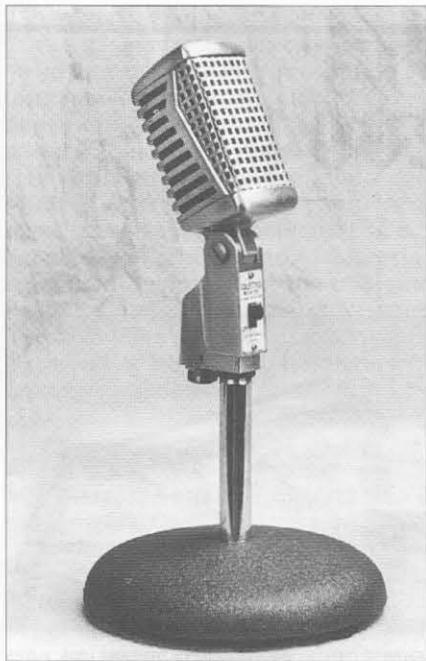
Foto 5. Esta réplica de buen aspecto del Astatic 77A es un Calectro Q-4, una copia muy barata y de sonido a hojalata fabricado en Japón en épocas pasadas. (Foto cortesía de W2CQ)
