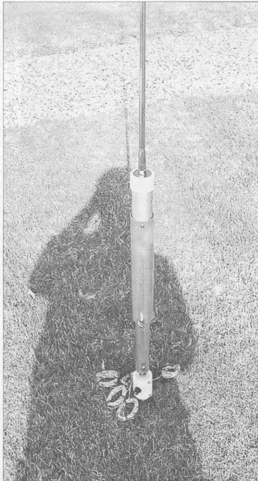
Foto 1. La MFJ-1664 también es una excelente antena para una estación portable o temporal. Puede montarse en el terreno con hilos radiales de 5 metros de largo.
