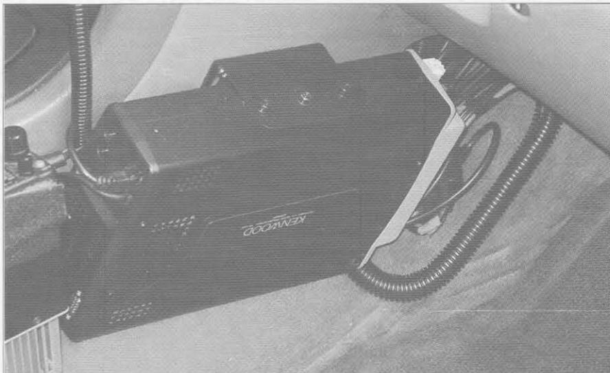
El cuerpo de la radio, montado en el compartimiento del pasajero. Véase que el cable del micrófono se conecta a la caja de la radio, no al panel de control. Si se desea montar el cuerpo de la radio en el maletero, se precisa el kit de extensión PG-4Z, de 4 m de largo, que facilita el empalme del micrófono hasta el interior del vehículo. (Foto N5FM).
