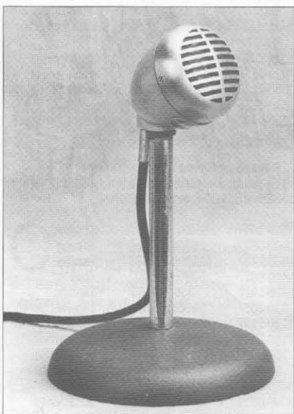
Foto 9. La primera reencarnación del famoso micrófono Astatic J-30 fue este Shure 440. Los cantantes y tocadores de armónica le desenroscaban el pie y lo mantenían en la mano; luego Shure le añadió un control de volumen en su base y lo denominó modelo 520DX. (Foto cortesía de W2CQ y fotografiado por VE3NGW)
