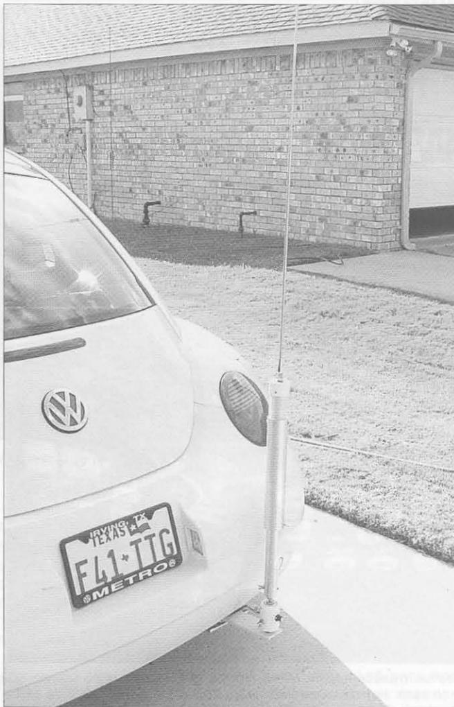
Foto 2. La MFJ-1664 montada en la parte posterior del automóvil del autor. La pieza blanca en el extremo inferior con un botón negro es la caja donde se cambia fácilmente el condensador de adaptación (ver Adaptación en la base).
