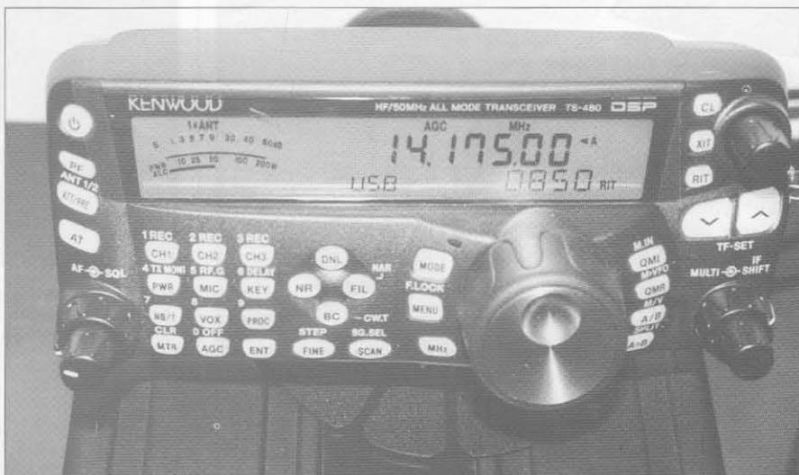
El TS-480 de Kenwood es un transceptor de HF+6 metros (incluyendo la banda de 60 metros) para uso móvil o en casa. Hay dos versiones: la de 200 W sin sintonizador de antena y la de 100 W con él. (Foto de WB6NOA).
