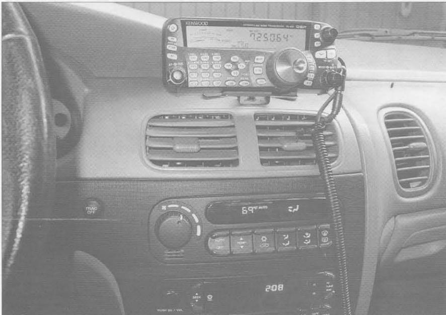
El cabezal de control del TS-480 puede instalarse en cualquier sitio justo encima del tablero de a bordo para tener un acceso fácil y seguro mientras se conduce. (Foto de N6FM).
