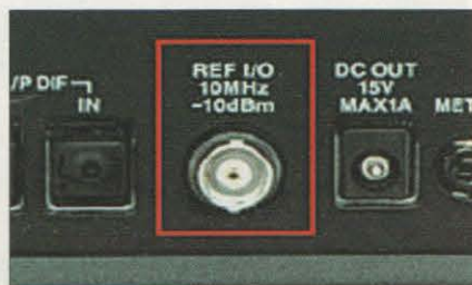
En el panel trasero se dispone de una toma para entrada/salida de señal de referencia a 10 MHz.
