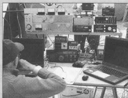
Los hermanos Prat aportaron a la instalación de rebote lunar una considerable cantidad de equipo propio, entre el que destaca un amplificador de 400 W de construcción casera. (Foto EA3ALV)
