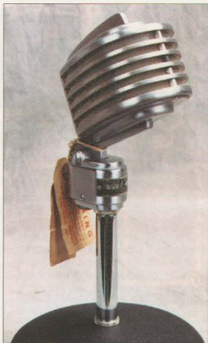
Foto 2. Las sólidas líneas curvas de este antiguo Turner, modelo 34X, le dan un aspecto serio y apropiado para una estación de radiodifusión que despierta inmediatamente nuestra atención. Estaba dotado de una cápsula a cristal, adecuada para equipos a válvulas, y fue utilizado incluso en películas de los años 50. Nótese las etiquetas originales de venta. (Foto cortesía de su propietario, W2CQ, y de VE2NGW)
