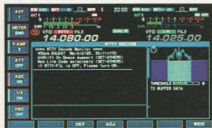
El IC-7800 incluye un codificador/descodificador interno de PSK31, que simplifica hasta el límite la operación en esta modalidad.
