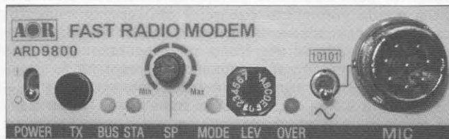
Hay muy pocos controles en el ARD-9800. En el panel frontal vemos un conector para el micrófono incluido con el módem, un control de volumen del altavoz interno y otro de ganancia de micrófono, así como un conmutador entre transmisión analógica y digital (la conmutación en recepción es automática). También hay un interruptor para forzar la transmisión, utilizable solamente en video digital.
