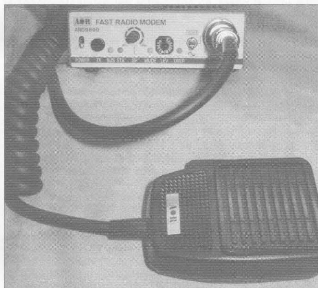
El módem ARD-9800 de la firma AOR es capaz de emitir y decodificar voz digital, texto e imágenes. Puede ser usado con prácticamente cualquier transceptor de HF con SSB, conectado a la entrada de micrófono y a la salida de altavoz.
