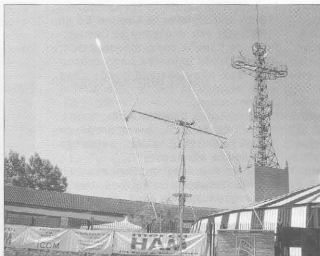
Vista de las dos antenas de 17 elementos 5WL usadas por EA3URC en el MercaHam.
