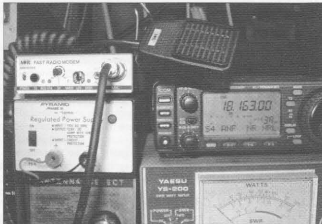
Un módem ARD-9800 "enchufado" a un IC-706; debajo, la pequeña fuente de alimentación para el módem. Es esencial alimentar el 9800 con una fuente regulada y no conmutada.
