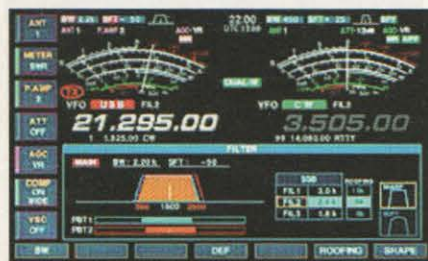
El usuario puede ajustar por DSP la banda pasante y la pendiente de los filtros de FI.
