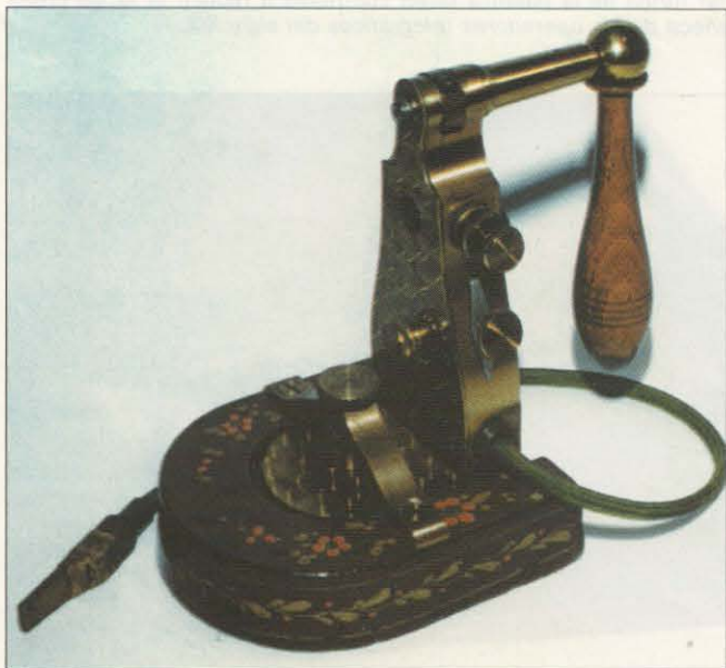
Foto 4. Para tratar de evitar el síndrome del carpiano cansado se desarrollaron multitud de llaves telegráficas alternativas a la clásica vertical. Pero esta increíble Pump Hand Key es completamente distinta. Se la opera tirando de la palanca, en vez de empujar un pomo. (Foto cortesía de K9WDY)
