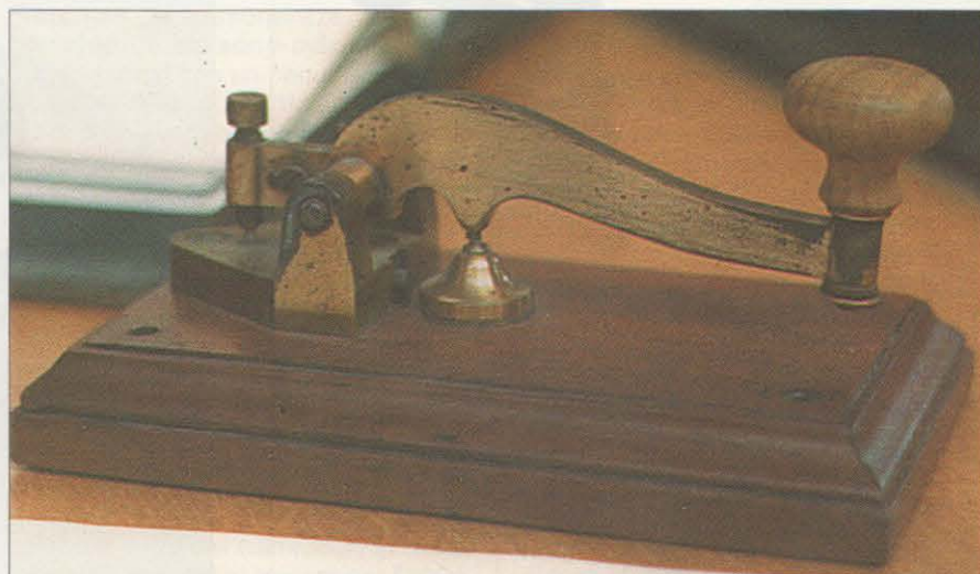
Foto 1. Este es un genuino ejemplar del manipulador Chubbock «giba de camello» que sirvió a Englar Wenk para crear sus reproducciones a tamaño normal o reducido. La pieza se conserva en un museo de Correos y Telégrafos de Alemania, y un ejemplar similar está en la colección de Gil Schlehman, K9WDY, en EEUU. (Foto cortesía de Gil Schlehman, K9WDY, maestro de coleccionistas).
