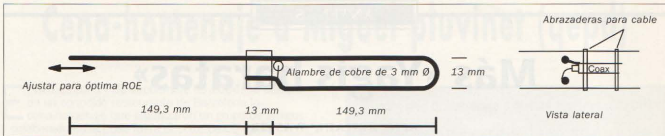
Figura 2. Elemento excitador para 435 MHz utilizado en las cuatro versiones de la "Yagi barata". (N. de R. En el artículo original las dimensiones vienen dadas para 445 MHz. Para adaptar la antena a 435 MHz se han aumentado las dimensiones un 2,24 %).
