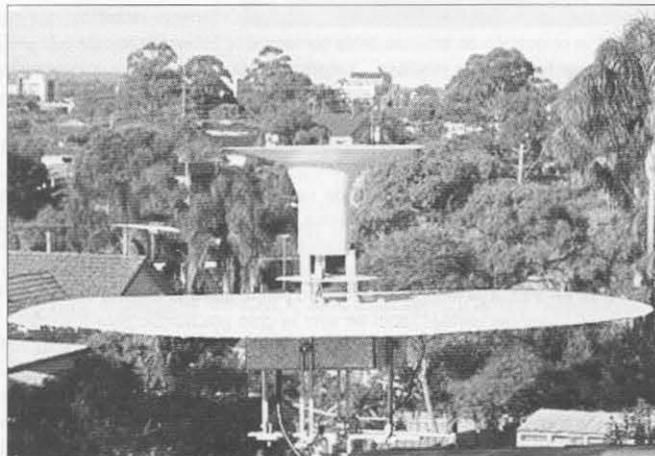
Foto 1. Antena CFA de VK2EDB para la banda de 20 metros (ver texto). El cono tiene un diámetro máximo de 40 cm, y el disco que forma el plano de tierra tiene 1,25 m de diámetro. Fuente: <[www.geocities.com/vk2edb/CFA.htm](http://www.geocities.com/vk2edb/CFA.htm)>
