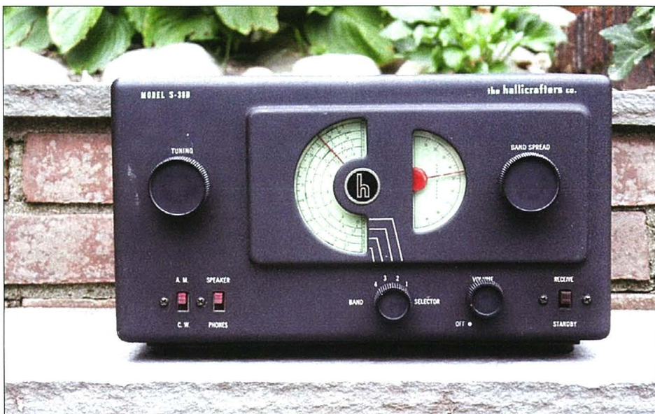
Foto A. El receptor S-38 de Hallicrafters, una joya de los días pasados. El receptor de la foto tenía cinco válvulas y cuatro bandas en mueble metálico con un acabado en corrugado negro. ¡Ah,... el resplandor de aquél dial verde! (Propiedad y fotografía de Gail Schieber, K2RED)
