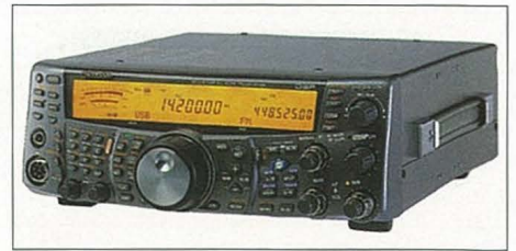
Foto 9. El Kenwood TS-2000 opera en HF, 6 y 2 metros, 70 cm. y tiene como opción la banda de 23 cm (1,2 GHz).
