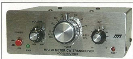
Foto 5. Transceptor de CW MFJ-9020 para 20 metros, entrega 5 W.
