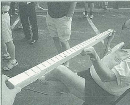
Foto D. ¡Si chicos, esto es realmente una antena!! Los elementos de 2,3 GHz fueron pegados en caliente a una viga hecha con un bloque de styrofoam. Aunque esta antena en particular no funcionó bien en las pruebas, el concepto de diseño es válido.
