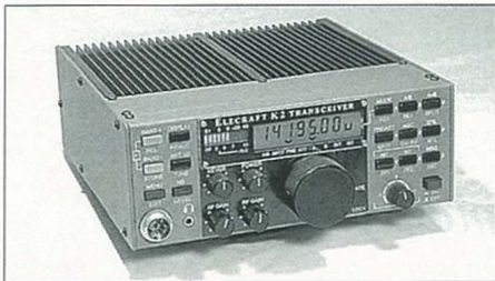
Foto 3. El equipo superior de la línea de Elecraft es el K2, que tiene todas las características y funciones de un transceptor de lujo de 10 W (y hasta 100 W con un módulo adicional). Gracias a la construcción modular, con todos sus componentes sobre la placa de c.i. se facilita mucho el montaje.
