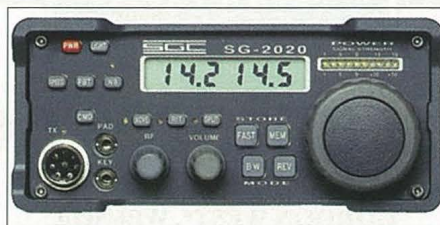
Foto 6. Transceptor SG-2020 de SGC, 20 W de salida.
