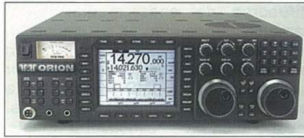
Foto 11. El transceptor Orion de Ten-Tec tiene recepción de triple conversión, y analizador de banda que permite monitorizar la actividad en las bandas en cinco segmentos de barrido seleccionables.
