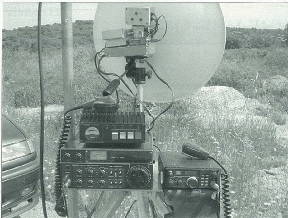
Estación portable para 10 GHz de EA5YB.
