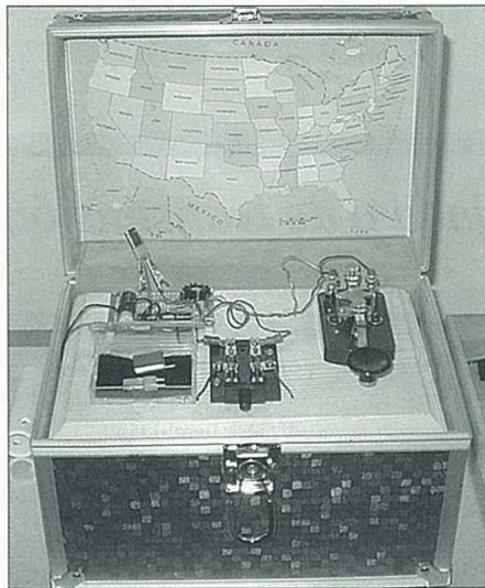
Foto 6. En este conjunto, preparado para acoplarse a la trasera de una motocicleta, Buzz, AC7RG ha combinado un transmisor Peanut Whistle II, un manipulador, una llave T/R a cuchillas, un receptor de OC y una antena YoYo, embalado todo en una sólida caja, capaz de soportar cualquier tipo de abuso.
