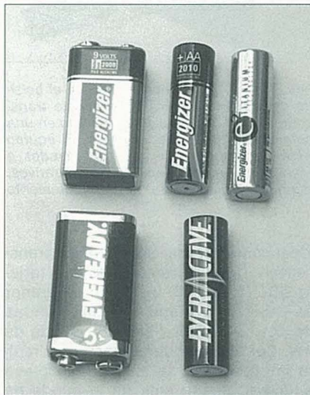
Foto 4. Recientemente, la tecnología de las pilas se ha expandido notablemente y las pilas alcalinas de las mayores marcas de pilas son ahora realmente poderosas fuentes de energía. La popular pila Energizer Max AA viene dada para 2,85 A/h, la E2 Titanium con 3,135 A/h y las baterías de 9 V de Eveready y Energizer son capaces de suministrar 625 mA/h.
