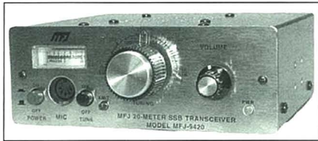
Foto C. Este transceptor "travel Radio" de MFJ entrega 12 Wpwp en SSB en las bandas de 10, 20, o 40 metros e incluye un medidor de S, un compresor vocal y un receptor sensible con filtro a cristal. Funciona muy bien en casa, en portable o incluso en móvil.
