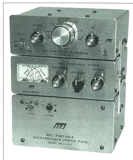
Foto B. Esta estación de MFJ para CW en montaje de tres pisos puede ensamblarse para nuestra banda favorita e incluye un transceptor de 5 W, un sintonizador de antena con instrumento de agujas cruzadas, una caja de baterías con cargador a red y una antena dipolo. Es un paquete completo, listo para actuar.
