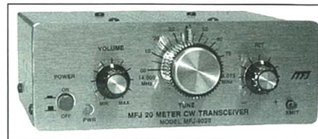
Foto A. La serie 90 de transceptores de MFJ son monobandas bien probados de precio económico y que funcionan bien. La unidad incorpora filtros a cristal, semidúplex o QSK, RIT y tono lateral. Cubre aproximadamente 150 kHz en la porción de CW de cada banda en particular. (Fotos cortesía de MGF Enterprises)
