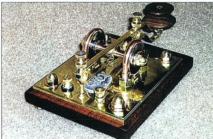
Foto 1. Haciendo un gran debut en este artículo especial tenemos el nuevo manipulador "Cliff Dweller", diseñado y fabricado por Dave Nicholson, W1YBR. Está dotado de un mecanismo en cobre y latón, finamente pulido y completo, con cojinetes y un sólido eje, un brazo de dos pisos todo ello sobre una base de madera de palisandro y con un pomo del mismo material. (Foto cortesía de W1YBR)
