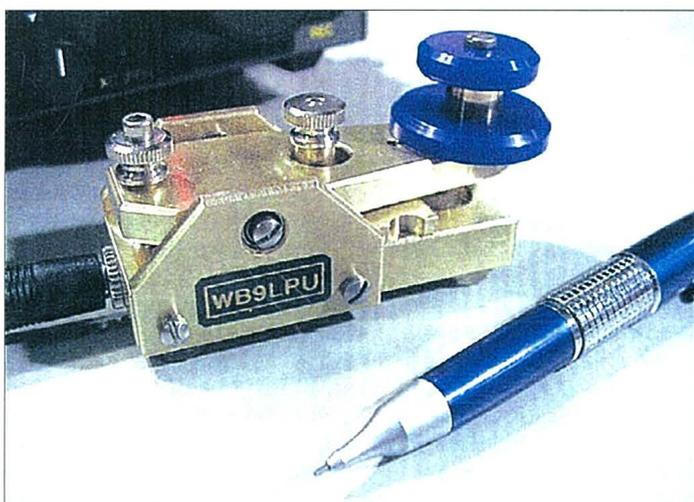
Foto 4. Vea este manipulador miniatura hecho por Richard, WB9LPU. Tiene una base de latón y cojinetes de bolas en el pivote, está dotado de un pomo azul brillante, tensado por imanes y resulta elegante y de un tacto agradablemente ligero. ¡Es una joya! (Foto cortesía de WB9LPU)
