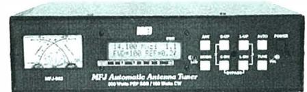
Este acoplador le permite la sintonía automática
