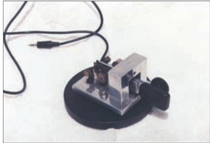
Foto 11 - Este manipulador de una sola pala, hecho también por James, KB4LJV, hace uso de un yugo de diseño casero y un brazo hecho con un trozo de hoja de sierra para la tensión y un asa de una tapa de olla como pomo. El conjunto queda protegido del polvo con una tapa hecha con un bote de comida para gatos, pintada de negro y que se ha retirado para hacer la fotografía. (Foto cortesía de KB4LJV)
