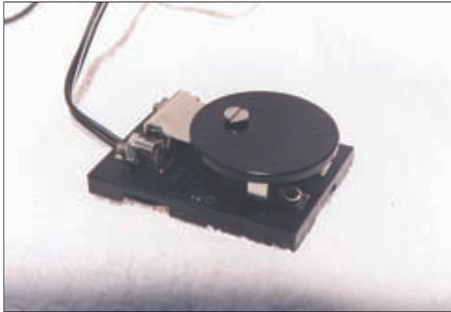
Foto 10 - James, KB4LJV, hizo este pequeño "tam-tam" telegráfico con una base de plástico, sacada de la tapa de una caja de PC, y con un disco de madera como pomo. Es simple, pero constituye un práctico manipulador portátil. (Foto cortesía de KB4LJV)
