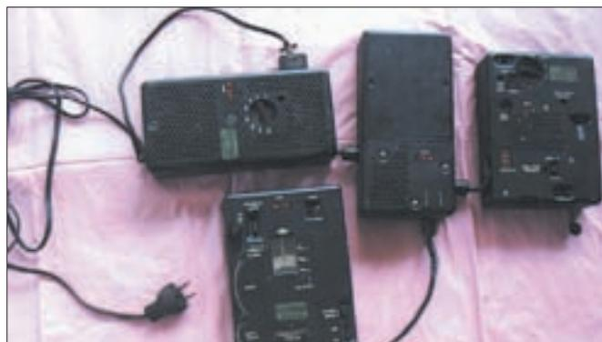
Foto C - Radio tipo OSS actualmente en manos de "Flying" Jack Camp, WA4AGS. Los equipos, de izquierda a derecha y arriba, son: Caja de conmutación, fuente de alimentación y transmisor. Debajo está el receptor. Jack dice que ocasionalmente utiliza este equipo en 40 metros, y que aún funciona bien. (Foto cortesía de WA4AGS)
