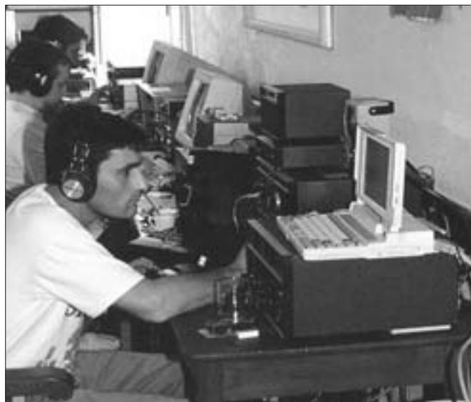
*Disposición típica de una estación multioperador con varios equipos. Las distancias entre equipos son "las posibles" en una instalación temporal en una vivienda. Lo ideal es separar considerablemente las distintas estaciones.*
