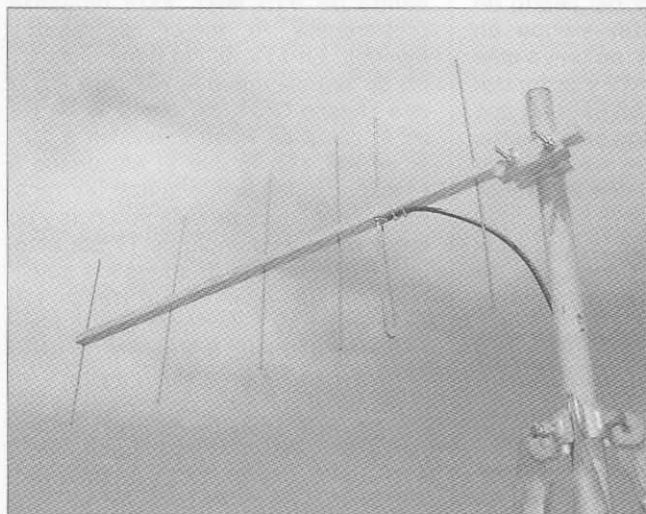
Foto A. Una antena barata para TVA, que cubre los dos populares canales de TVA en el extremo inferior de la banda de 70 cm.
