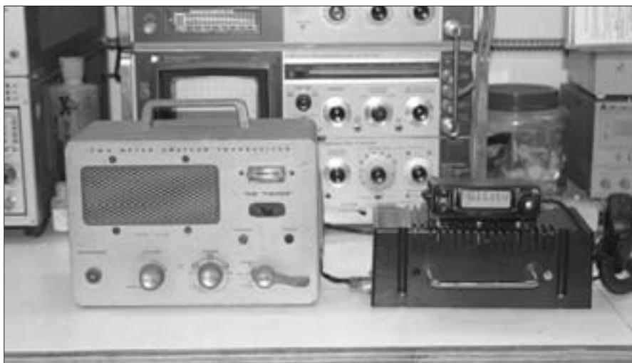
Foto A. La caja de la izquierda es una “fiambarrera de Benton Harbor” para 2 metros, acaso una de las primeras radios “portátiles”. A la derecha vemos un sistema portable autónomo, formado por un pequeño transceptor móvil y un sistema de alimentación ininterrumpida a batería.
