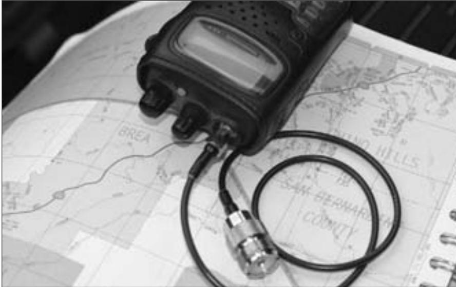
Foto B. El coaxial grueso y su conector pueden sobrecargar mecánicamente la radio portátil, así que puede ser una buena idea añadir un trozo corto de cable coaxial flexible entre la radio y el cable que va a la antena.
