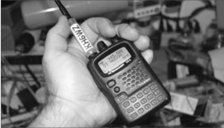
Foto D. Si usa una antena larga con una radio portátil, trate de sujetar ambas de modo que se reduzca el riesgo de aplicar esfuerzos excesivos al conector de antena de la radio. Observe que el extremo inferior de la antena ha sido recubierto con una funda de plástico para reducir el efecto de la mano sobre la antena al transmitir.
