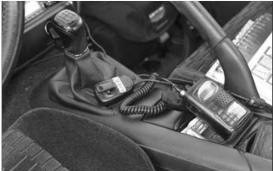
Foto C. Una estación móvil lista para funcionar. Si su walky tiene un conector SMA (como el del Yaesu VX-5 de la foto) se puede interponer un trozo corto de cable entre el walky y el cable de la antena para reducir los efectos de torsión y el riesgo de roturas en la radio.
