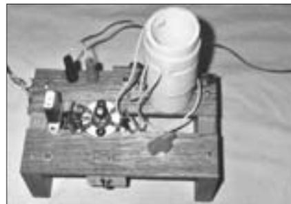
Foto E. Otro impresionante trabajo artístico es este transmisor con una sola válvula "bellota" 955 y controlado a cristal, es el construido por Walt Bullerwell, KF4YJQ. Advértase la disposición clásica del "chasis" que se usó en los transmisores con 6L6, como el descrito en el número de 256 de CQ (mayo 2005).
