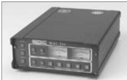
Foto C. La firma SGC anunció recientemente el MAC-200, un Sintonizador/Acoplador automático que cubre entre 1,8 y 60 MHz, pudiendo manejar hasta 200 W. El equipo difiere de un sintonizador corriente en que permite acoplar dipolos, directivas y verticales además de hilos de cualquier longitud, además de antenas alimentadas con línea abierta, como los dobles multibanda y las Zeppelin. (Ver texto)
