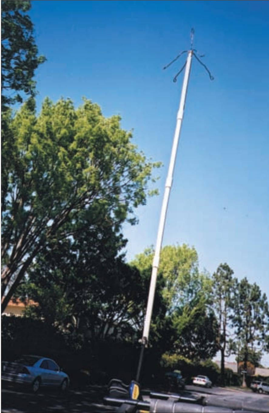
Foto C. La antena de plano de tierra y plegable, completamente extendida y afirmada en el portaequipajes de mi vehículo. ¡Recuerde su altura si se mueve con ella instalada! Para operación "DX a pie", esta antena puede fijarse a los herrajes de una mochila. Pueden variarse el número y longitud de los trozos de tubo para ajustar la longitud deseada.
