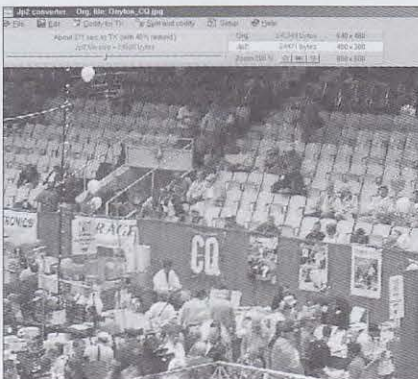
Foto 2. La imagen de la foto 1 pero comprimida en forma de un fichero JP2 de 25 kB mediante la utilidad incluida en DIGTRX. A este nivel de compresión (la imagen tiene un 10% del tamaño de la original) la diferencia en calidad es difícilmente apreciable, con tan sólo unas pocas irregularidades.
