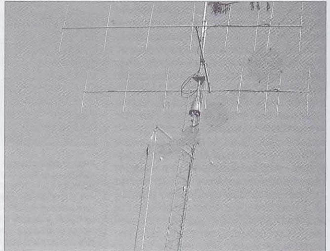
El dipolo "gordo", suspendido por su centro de un brazo fijado a la torre, resulta muy transparente.
