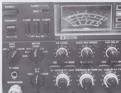
Foto A. La mayoría de transceptores de gama media o alta incluyen cancelador de ruido de gran eficacia, ajustable desde el panel frontal. La foto muestra el frontal del antiguo ICOM IC-761, se observan los mandos del cancelador de banda ancha (NB WIDE) y del de banda estrecha (NB). Los de banda ancha fueron diseñados originalmente para minimizar el "pájaro carpintero" o ruido de los radares transhorizonte, pero también resultan útiles para a contrarrestar el chirriante ruido de las PLC.
