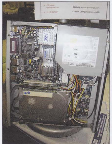
Foto C. El sistema Hamation Shack-LAN de control de la estación para aficionados a los concursos tiene como centro este ordenador, que funciona ¡a 12 voltios corriente continua!
