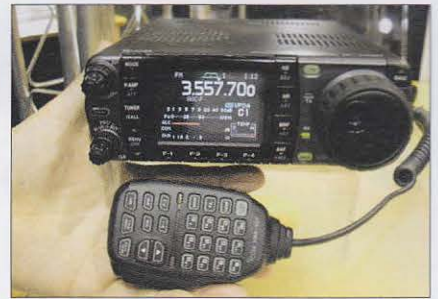
Foto N. Una novedad más de ICOM en Dayton fue el IC-7000, un equipo para las bandas de HF/VHF/UHF que en un tamaño adecuado para móvil incorpora varias funciones de procesado digital de señal propias de los transceptores más sofisticados de la marca.
