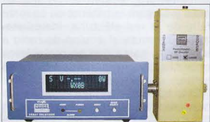
Foto L. El PowerMaster de Array Solutions es un vatímetro y medidor de ROE controlado por software; dispone de un sensor de RF separado y el software permite configurarlo de acuerdo con las necesidades.
