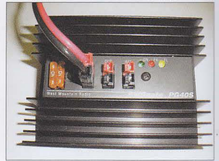
Foto T. el PWRgate PG40S de West Mountain Radio es una combinación de cargador de batería y suministro de energía de emergencia (empleando una batería no incluida). Por un lado se conecta a la red eléctrica y a una batería, y por otro a equipos de radio que funcionen a 12 voltios. En condiciones normales, suministrará energía a los equipos de radio y a la vez cargará la batería; si se produce una interrupción del suministro de red, el PWRgate de inmediato conmutará la batería, permitiendo que los equipos de radio continúen funcionando.
