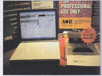
Foto F. El receptor estilo "caja negra" AOR SR-2200 (casi oculto tras la etiqueta roja) no tiene botones, mandos ni pantallas: su control se realiza íntegramente desde un ordenador con los programas incluidos.
