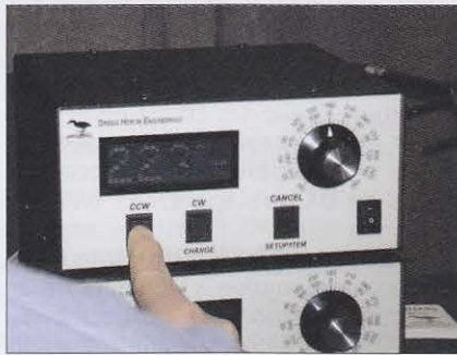
Foto H. El controlador de rotores digital RT-20 de Green Heron Eng. permite el control manual o automático de múltiples rotores, incluso de distintos fabricantes.
