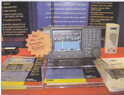
Foto Q. El monitor de bandas de AOR SR-2000, tiene un receptor incorporado y muestra en pantalla el espectro en un ancho de banda de hasta 10 MHz dentro del margen de cobertura del receptor (desde 25 MHz hasta 3 GHz).
