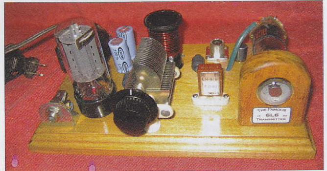
Foto A. Usando como base uno de los clásicos montajes con 6L6, Bob Russell construyó este bonito transmisor, con todas sus conexiones por debajo de la base de madera y un indicador de sintonía a "ojo mágico", que le añade atractivo.
