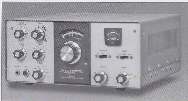
Foto 4. El transceptor HW-101 de Heathkit estuvo presente en los cuartos de radio de los aficionados más que cualquier otro equipo de la marca.
