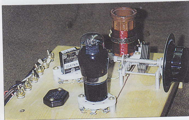
Foto D. Regresando desde las páginas del Radio Handbook 1935 de Frank Jones, tenemos a este transmisor a push-pull único, con una válvula 6A6, construido por Mac Neill, W8ZNX. (Foto cortesía de W8ZNX)
