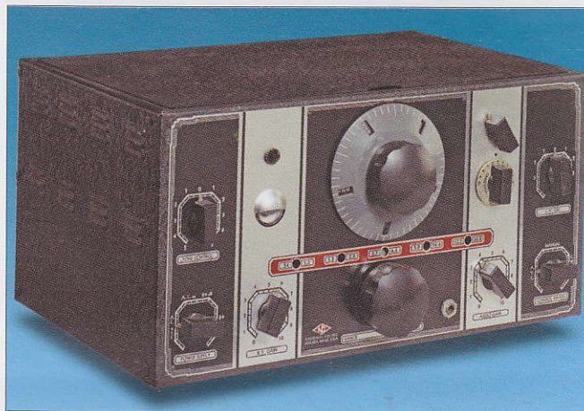
Foto 1. El receptor de cobertura general (0.54-30 MHz) NC-100X de National es el pariente original de la versión para bandas de aficionados NC-101X (Fotos del autor)
