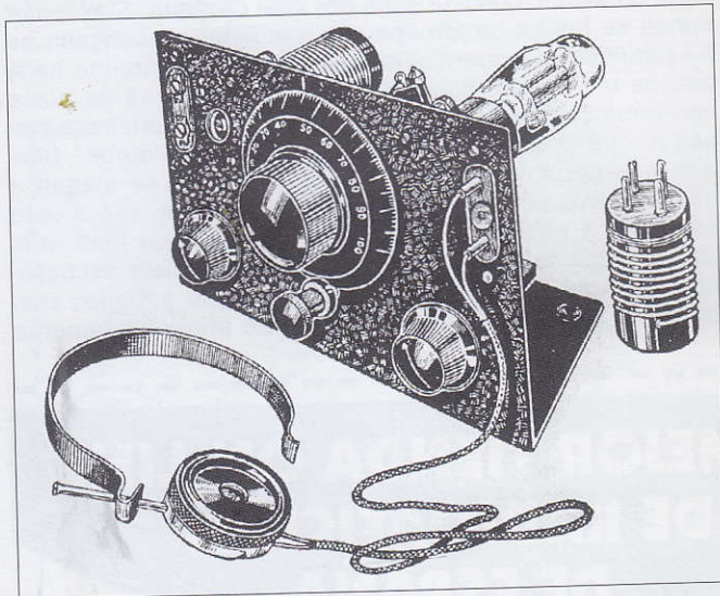
Figura 3. Dibujo original del receptor Twinplex que vendía como kit la RadioTrading Company. La válvula y la bobina en posición horizontal hace a este kit único. El mando de sintonía incorporaba un reductor a fricción y la radio se vendía por 4,91 $ en 1934.
