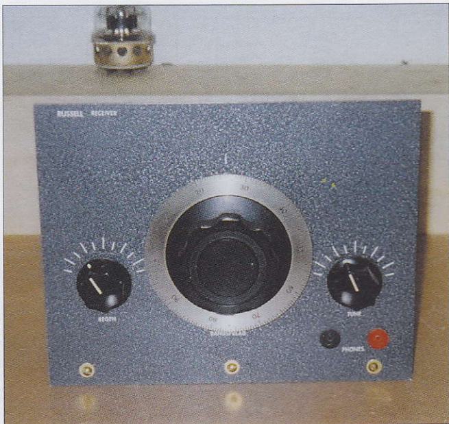
Foto C. Vista frontal del receptor Twinplex 1934 construido por WD4PAQ. Es un ejemplo clásico de simplicidad y elegancia. (Fotos cortesía de WD4PAQ)
