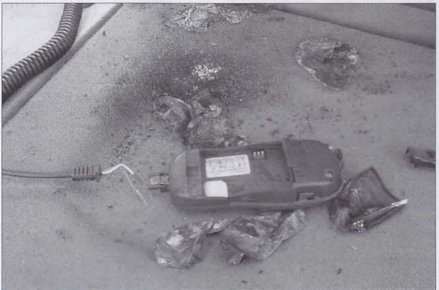
Foto A. Un teléfono móvil con una batería de marca desconocida que reventó cuando era recargado en el coche.
