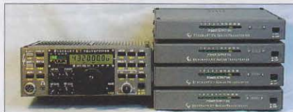
Foto B. Los cuatro transversores de la serie XV de Elecraft se muestran a la derecha, al lado del transceptor Elecraft K2. El nuevo XV432 es el situado arriba de todo. (Foto cortesía de Elecraft).
