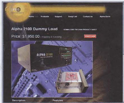
Figura 1. El sistema de refrigeración por radiador y aire forzado, los ventiladores controlados por temperatura y múltiples medidas disponibles, son algunas de las características de la carga artificial Alpha 2100. (Imagen cortesía de Alpha).
