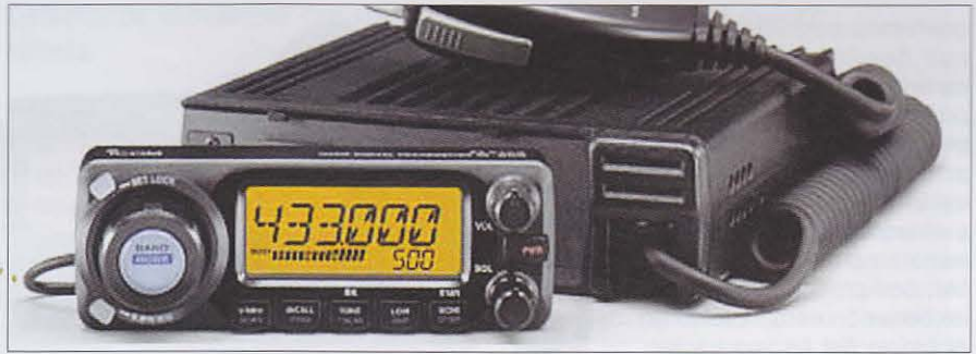
El equipo IC-800 de ICOM es bibanda (2m/70cm) que incluye el sistema D-STAR que permite transmitir voz analógica así como datos y voz digital por medio de D-STAR (Foto cortesía de ICOM America).
