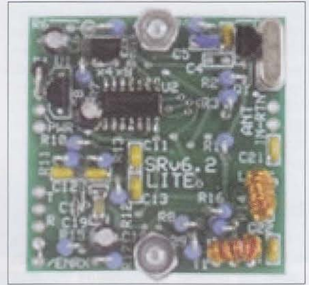
Foto E. Uno de los minúsculos receptores SDR monobanda de la serie SoftRock. (Foto cortesía de Waters & Stanton).
