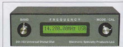
Foto C. El dial digital universal DD-103 de la firma ESP, proporciona exactitud digital a los receptores antiguos. Su funcionamiento se basa en medir tan sólo la frecuencia del oscilador local (OFV). Toda la información de desplazamiento de OFV y banda es almacenada en la memoria del dispositivo. (Foto cortesía de ESP).
