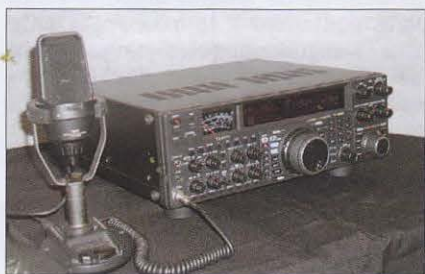
Foto A. El nuevo transceptor Yaesu FT-2000 es la evolución de la serie FT-DX9000. ¿Está este transceptor de última generación destinado a ser la pieza central de la estación de HF/50 MHz del lector? (Foto del autor).
