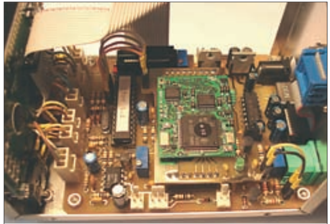
Foto A. Vista interna del módem para voz digital D-STAR desarrollado por Antonio, EA3CNO. Permite operar en este modo con transceptores de FM que dispongan de puerto de datos a 1200/9600 bps (ver texto). Fuente: sitio web del proyecto.
