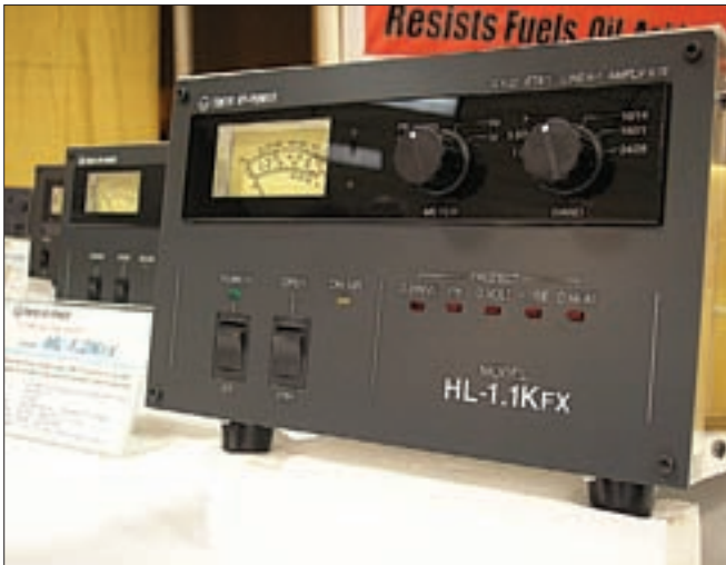
Los nuevos lineales de Tokyo Hy-Power son el lineal de estado sólido y 600 vatios de salida nombrado HL-1.1Kfx de la imagen adjunta y un lineal de 45 vatios, el HL-45, para utilizar con el QRP de Yaesu FT-817.
