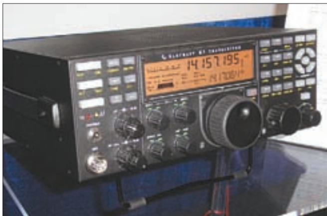
El transceptor Elecraft K3 representa un nuevo concepto de montaje en kit modular que te permite utilizar un manipulador de palas lateral para trabajar en RTTY y PSK-31 sin necesidad de un ordenador (fotos de W2VU a menos que se indique).
