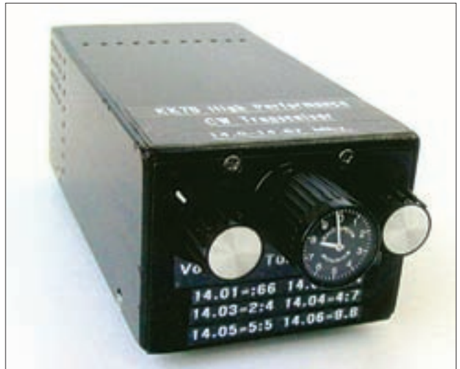
Foto E. Transceptor de CW High Performance montado por Dennis Payton, N9JXY. Cubre los 20 metros, y el mando de control de sintonía es un multivuelta de Bourne Electronic con un reloj tipo altímetro para conseguir una mayor precisión. ¿Cuanto cuesta ese botón de mando? ¡No lo preguntes! (Foto cedida por N9JXY).
