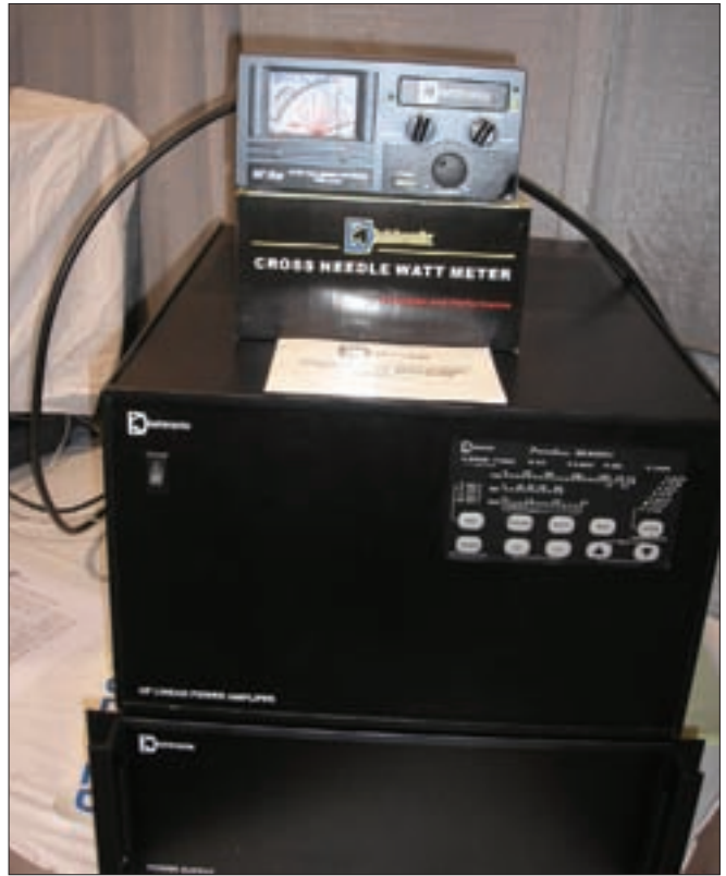
Dishtronix ha presentado dos elementos relacionados en Dayton este año: el amplificador de estado sólido Prometheus para 160 a 10 metros (caja grande de la foto), así como un medidor de ROE y vatímetro DWM-2104 (la pequeña caja de encima) para HF y la banda de 6 metros.
