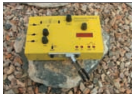
Foto B. Vista frontal del nuevo transceptor "de campo" para tres bandas de Hendricks QRP Kits, el PFR3, con las palas de manipulación en CW opcionales.
