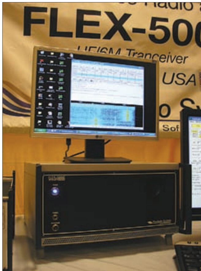
El FLEX-5000C de FlexRadio es el nuevo SDR que incluye todo un ordenador en su interior y dispone de un segundo receptor opcional que puede compartir el display panorámico o en cascada del receptor principal.
