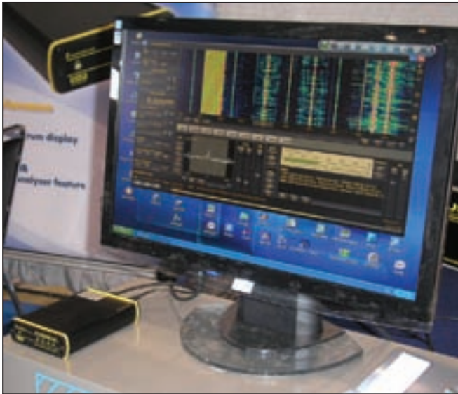
El receptor Perseus (la cajita de abajo a la izquierda), es un equipo SDR que necesita un ordenador. Tiene la posibilidad de grabar un segmento de 800 kHz y reproducirlo completo para sintonizarlo posteriormente como quieras.
