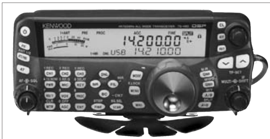
Foto B. Un ejemplo de buena elección es este transceptor "económico" de HF, el Kenwood TS-480SAT de 100 vatios o el TS-480HX de 200 vatios. Cada uno de ellos dispone de filtros DSP, reductor de ruido DSP, procesador de voz digital para SSB, manipulador electrónico incorporado, aparte de numerosas prestaciones adicionales. Son fáciles de utilizar, fiables y asombrosamente asequibles.
