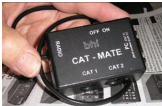
El CAT MATE de BHI LTD es un separador en Y que permite utilizar dos dispositivos por el puerto de entrada de ordenador de ciertos transceptores Yaesu.
