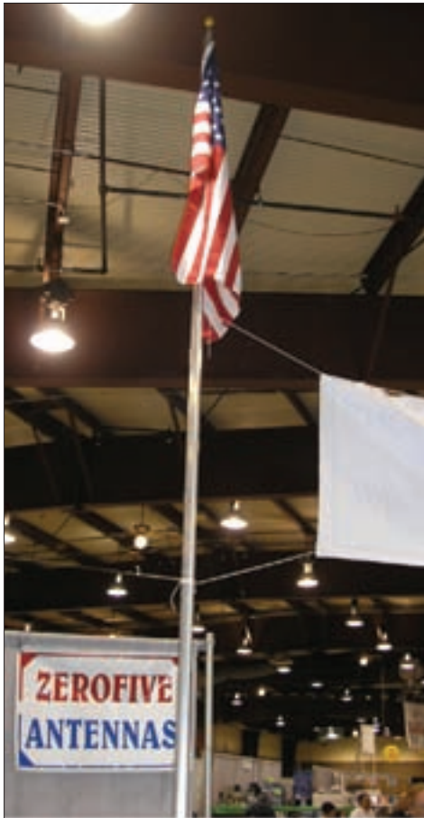
¡En pie para recibir la bandera! Este mástil "de bandera" es también una antena que soporta la máxima potencia legal desde los 40 a los 10 metros. Está fabricada por ZeroFive Antennas y distribuida por Array solutions.
