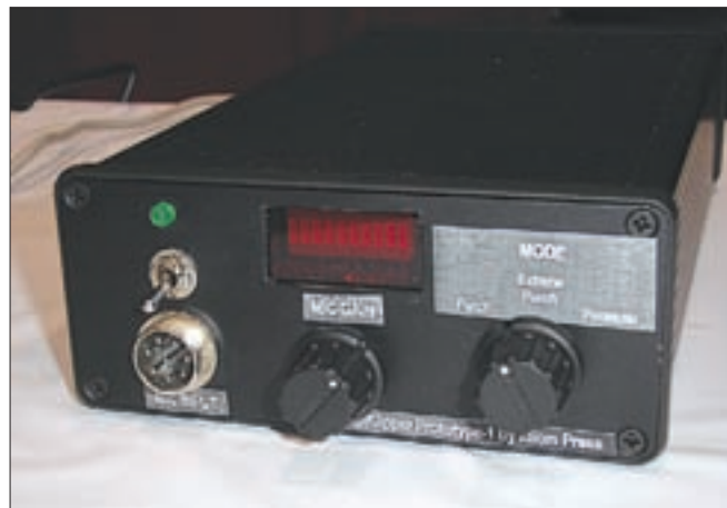
El LogiKlipper de Idiom Press es un procesador de audio para BLU o SSB que ofrece tres posiciones: Punch, Extreme Punch y Penetrate, para conseguir que tu señal llegue incluso en las peores condiciones.
