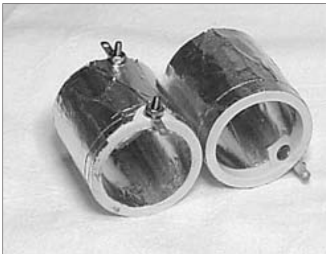
Foto A. Condensadores caseros que muestran los tornillos que conectan con la cinta de aluminio interior y exterior.
