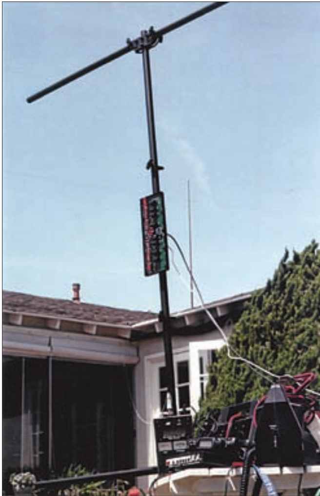
La antena TW-2010 montada y funcionando para la prueba, con la caja de conmutación de relés abierta. Se aprecia el cable de control y la línea coaxial saliendo de la caja con aproximadamente un ángulo de 45 grados. Esto es fundamental para mantener la ROE al mínimo (ver el texto).
