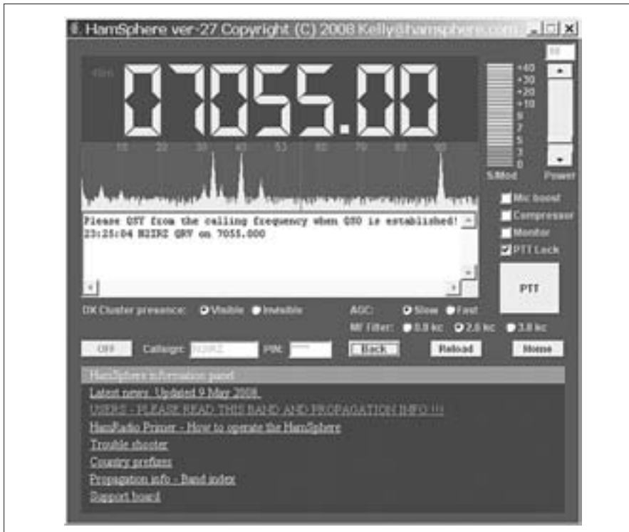
Pantalla principal de HamSphere. Después de arrancar el programa y conseguir abrirle paso por entre mis cortafuegos, empecé a recibir. HamSphere aparece exactamente como una banda de radioaficionados auténtica. Debajo de la pantalla panorámica principal, aparece un DX Cluster que muestra las estaciones que están "en el aire" (conectadas).
