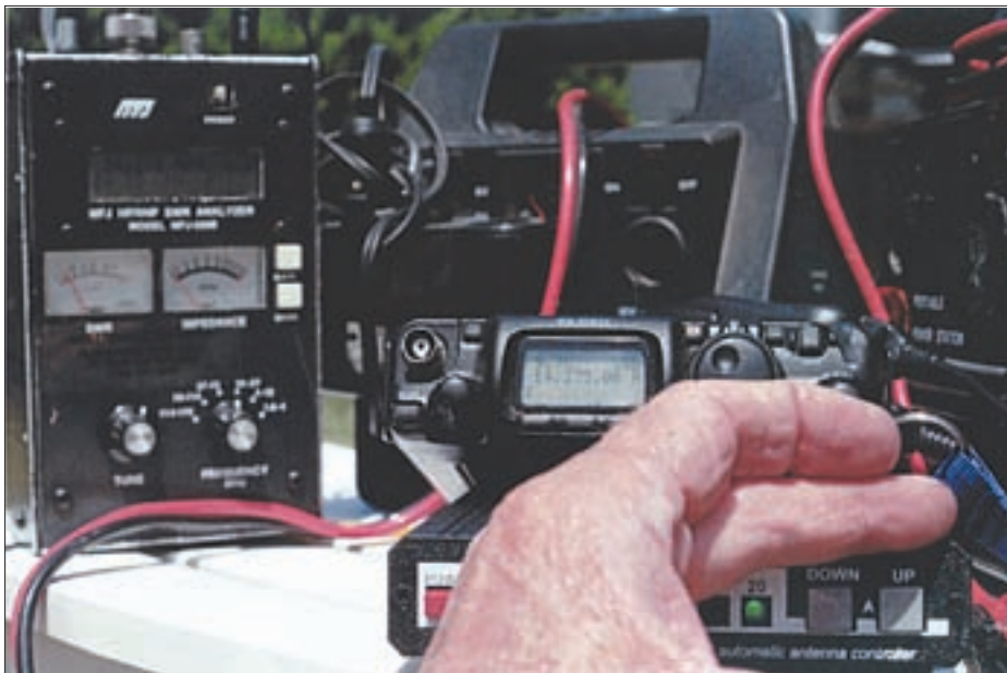
El diodo LED verde de la caja de control (sombreada con la mano para que puedas verlo brillar) muestra que los relés están en la posición de los 20 metros con la caja de control apagada. Los botones arriba/abajo permiten seleccionar las demás bandas y los LEDs indican en que banda está activa.
