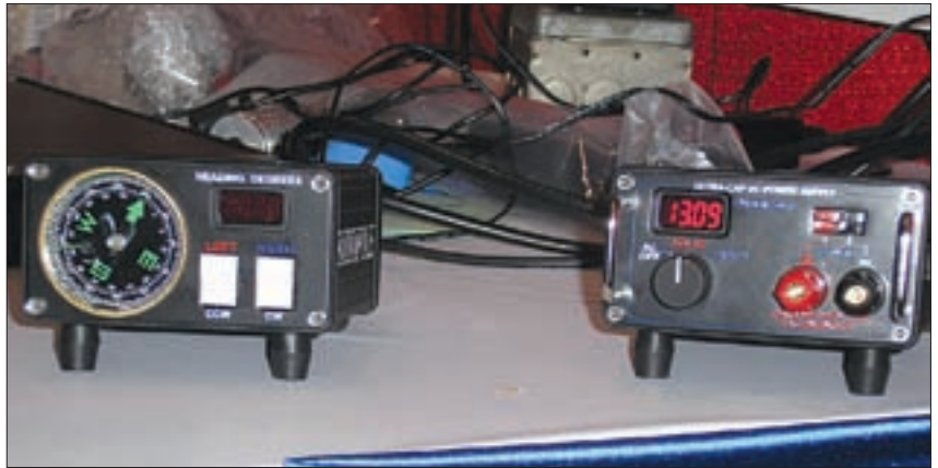
Dos nuevos accesorios de Buddipole Antennas son un controlador de rotor (izquierda) y una fuente de alimentación mini de 40 amperios (derecha) que utiliza un ultracondensador para almacenar la energía.
