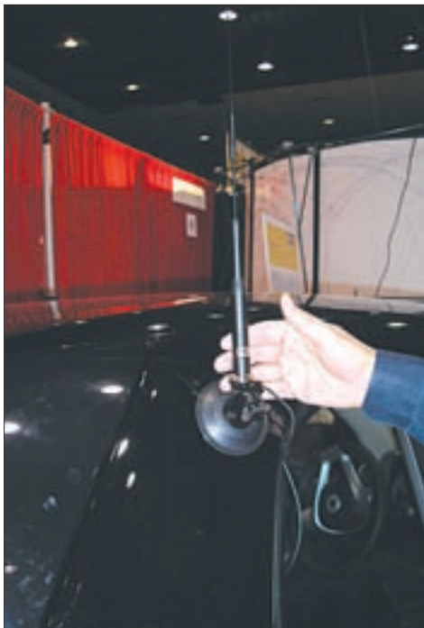
La Comet MRS4M es una combinación de base magnética y a succión que permite inclinar la antena en cualquier edirección
