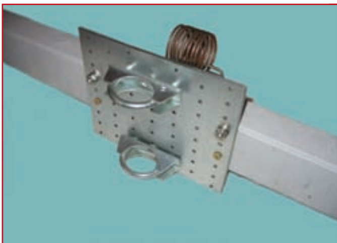
Fotos D1 y D2. Se muestra la disposición de fijación del listón mediante una placa perforada de ferretería y grapas en U para tubo de escape. Esta disposición proporciona una buena rigidez mecánica al conjunto.
