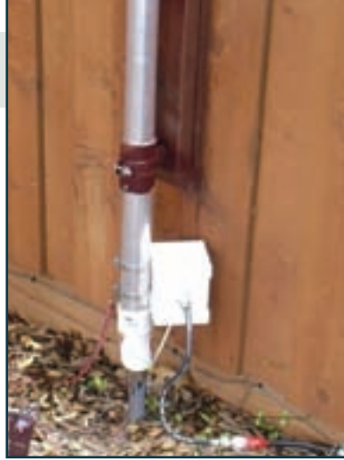
Foto B. La Hy-Gain AV-6160 es una antena vertical autosoportada para las bandas de 160 a 6 metros. Tiene una altura de 13,1 metros incluida la base.
