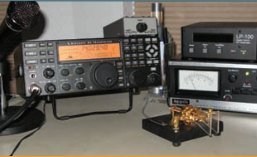
Foto A. Vista frontal del transceptor Elecraft K3 en la estación de W9KNI (foto cedida por W9KNI).
