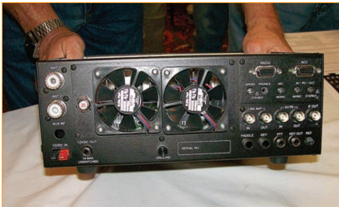
Foto B. Vista posterior del K3: Obsérvese los dos ventiladores, la cantidad de entradas y salidas y el conector Power Pole de Anderson de alimentación (Foto cedida por Cecil Bayona K5NWA).
