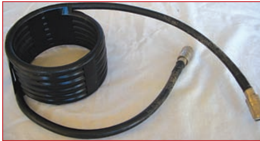
Foto C. El choke de coaxial que actúa como balun está hecho con un trozo de 2,1 m de cable RG-8/U (o RG-213) arrollado formando una bobina de seis espiras y dotado de conectores PL-259 en cada extremo.
