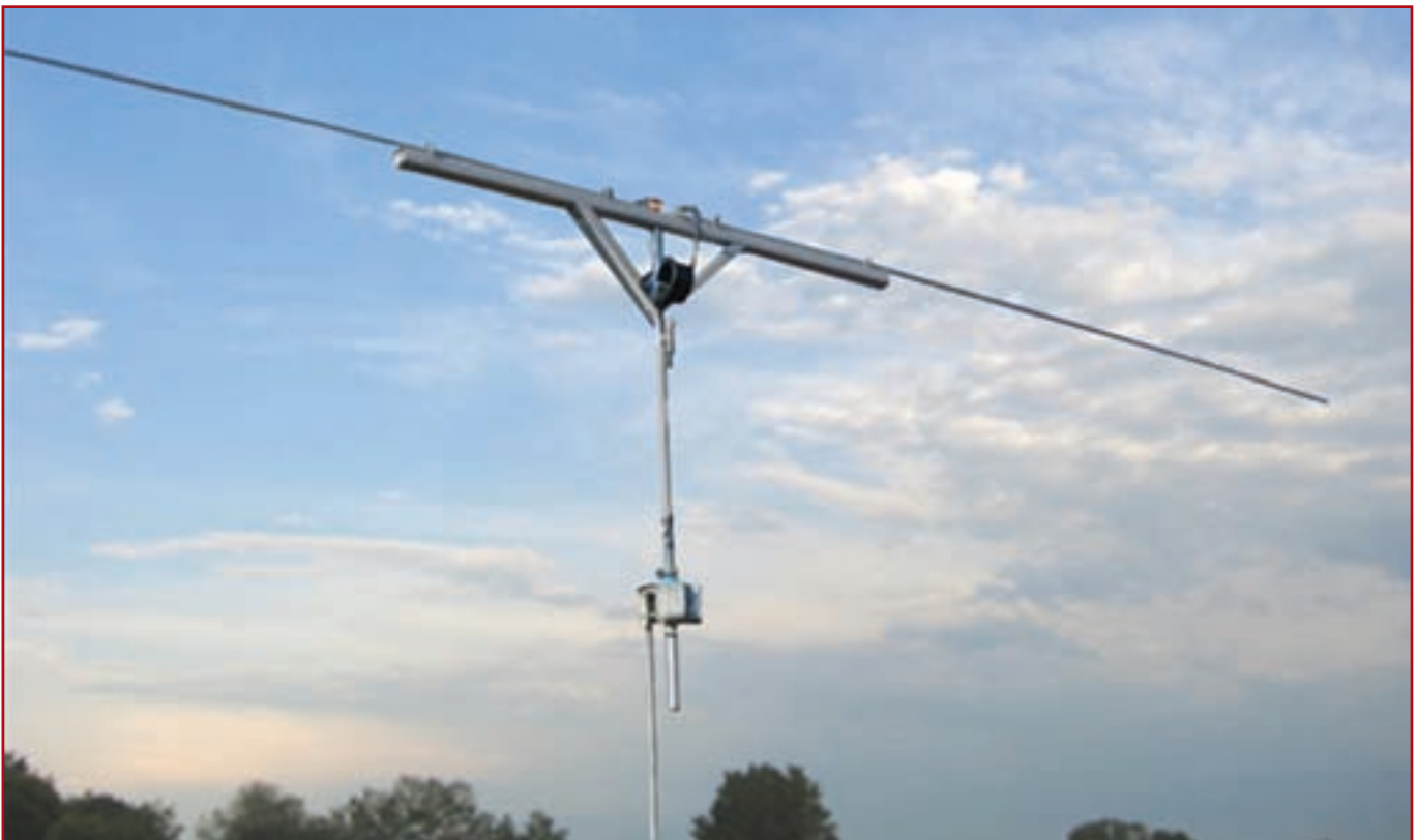
Foto A. Adaptación de W1XX de la clásica antena dipolo rotativo para 21 MHz descrita por Lew McCoy a mediados de la década de 1950. La antena fue montada sobre un corto mástil y dotada de un rotor para TV.
