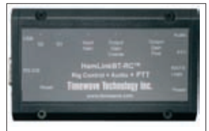
Foto C. El nuevo controlador inalámbrico de equipos HamLinkBT-RC de Timewave es un dispositivo Bluetooth que permite transmitir y recibir audio, controlar el equipo de radio y proporciona conectividad PTT, todo ello para operación remota de equipos de radio con interfaz de control RS-232, CAT ó CI-V.
