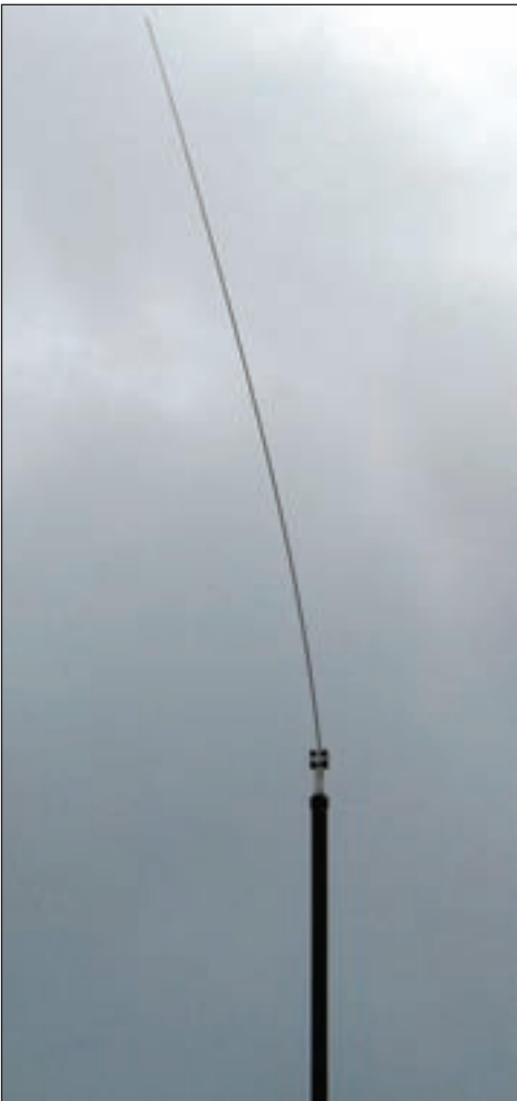
Foto E. Escuadras de montaje de vallas y tubo de PVC de 5 centímetros soportan la antena. El PVC fue pintado de marrón para adaptarlo al color de la valla.
