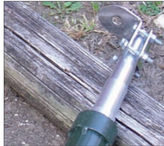
Foto C. Una manera de montar una antena de CB tipo "látigo" en lo alto de las secciones de tubo de aluminio.
