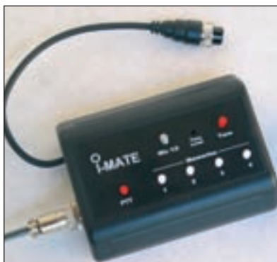
Foto B. El I-Mate de BetterRF implementa la selección externa de mensajes de voz, datos y CW pregrabados, para varios de los transceptores ICOM recientes (ver texto).
