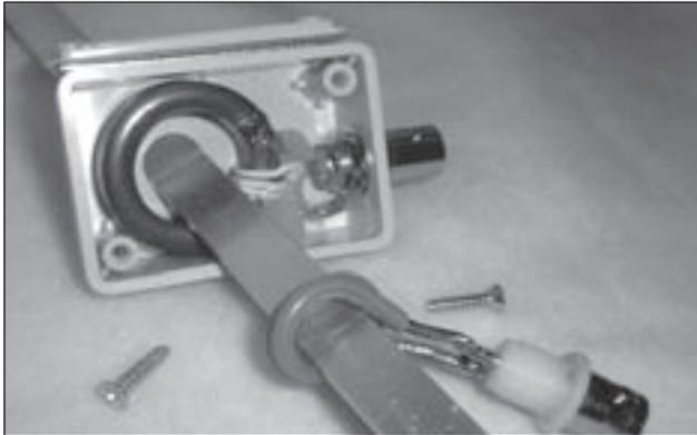
Foto E. Ajustando el acoplador magnético en mi versión de 6 metros.
