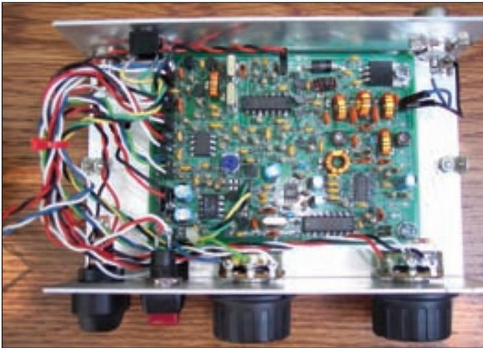
Foto 3. La vista interior del Firefly nos revela un circuito relativamente pequeño. Las señales en cuadratura I y Q del Firefly son procesadas por un ordenador, que le proporciona las prestaciones de un gran equipo.
