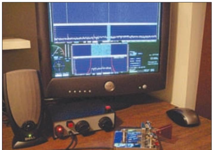
Foto 2. ¡El QRP más moderno es un SDR! Fred Saas, WA8PGE, trabaja los 30 metros con su pequeño *Firefly*, un QRP definido por software con una caja con sólo dos mandos y un pulsador y el portátil. El ratón funciona con un manipulador de palas de MFJ y el altavoz emite unos buenos tonos de CW. (Foto cedida por WA8PGE).
