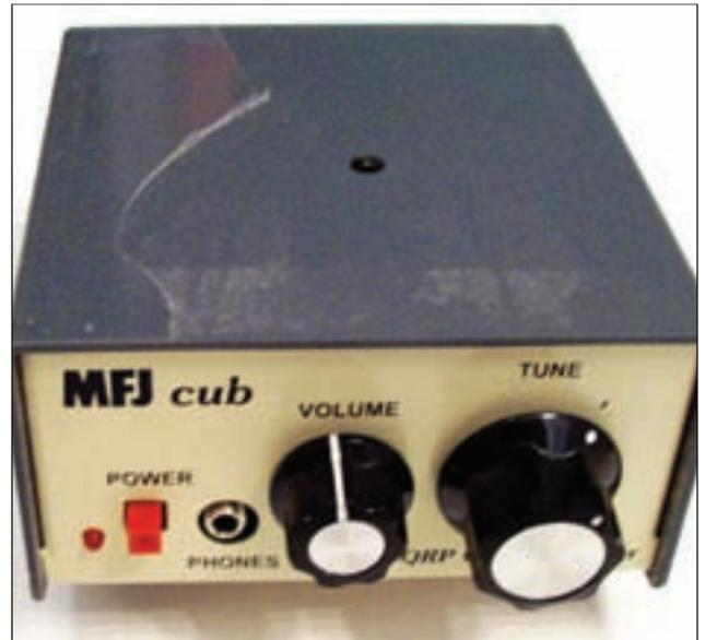
Foto 10. El Cub (cachorro) de MFJ es un transceptor QRP muy popular que normalmente proporciona 2 vatios de salida. Un simple cambio del transistor final permite aumentar la potencia hasta 3 o 4 vatios y convertirlo en toda una versión superior (Foto cedida por MFJ Enterprises).
