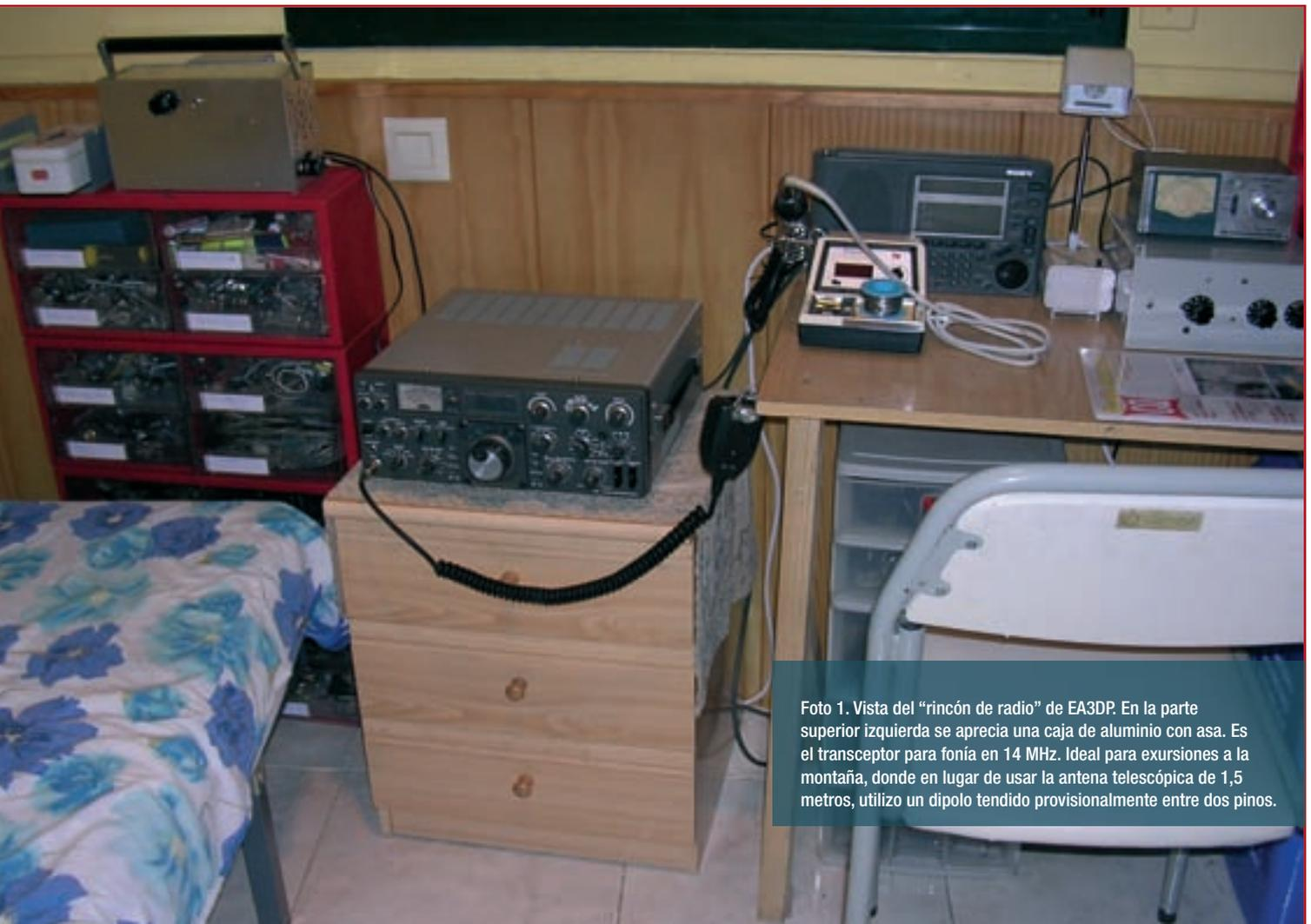
Foto 1. Vista del "rincón de radio" de EA3DP. En la parte superior izquierda se aprecia una caja de aluminio con asa. Es el transceptor para fonía en 14 MHz. Ideal para excursiones a la montaña, donde en lugar de usar la antena telescópica de 1,5 metros, utilizo un dipolo tendido provisionalmente entre dos pinos.
