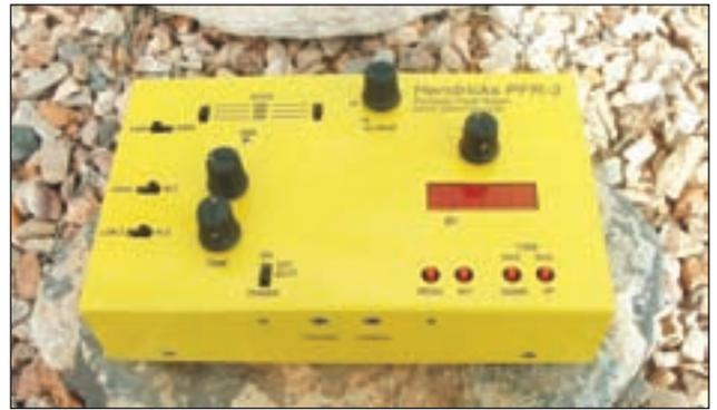
Foto 5. El nuevo PFR-3, un transceptor SDR en kit para CW en 40/30/20 metros que procede de [www.qrpkits.com](http://www.qrpkits.com) y dispone de un buen receptor con un filtro de 300 Hz, un transmisor de 5 vatios, un acoplador de antena, un manipulador con memorias y mucho más. Instala ocho pilas AA en el interior y tendrás un transceptor portátil completo (Foto cedida por KI6DS).
