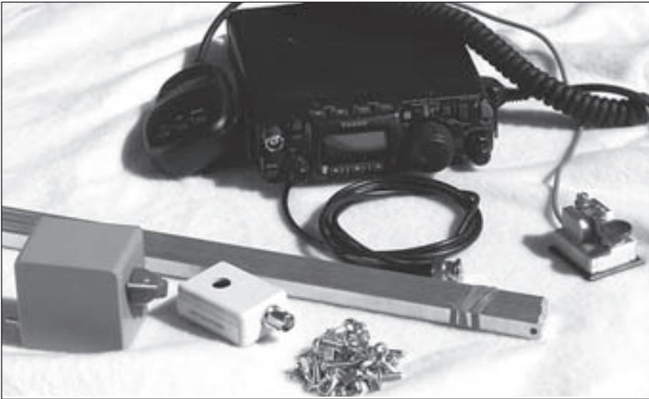
Foto A. Listo para operar en QRP en 40, 30 y 20 metros con la antena de cuadro plegable de G4TPH.
