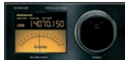
Foto B.- Consola CP-1000 de control táctil para programas SDR, de Wood Box Radio. Se observa el mando de sintonía, el contador de frecuencia y el S-meter. Es conectado al ordenador en que esté funcionando el programa SDR mediante un puerto USB.
