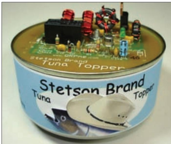
Foto 7. Tripas a la vista de un genio del milivatio. Esta lata es lo que necesitas. Es un amplificador de RF para 40 metros en kit y muy fácil de construir que aumentará la potencia de tu transceptor *Tuna Tin 2*. Cualquier otro equipo similar, como el DC-40 o el *Rockmite*, proporcionará con él 5 vatios de salida y se consigue de W1REX en <[www.qrpme.com](http://www.qrpme.com)> (Foto cortesía de W1REX).
