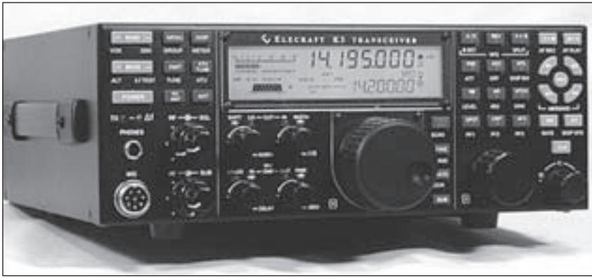
Foto 6.- Muchos aspectos de la radioafición no necesitan ser complejos o caros de abordar y el mundo del QRP es un gran ejemplo. Este transceptor Elecraft de 10 W es un sueño del QRPero con prestaciones extraordinarias y que encaja en la estación más reducida que puedas imaginar. Más detalles en <[www.elecraft.com](http://www.elecraft.com)>.
