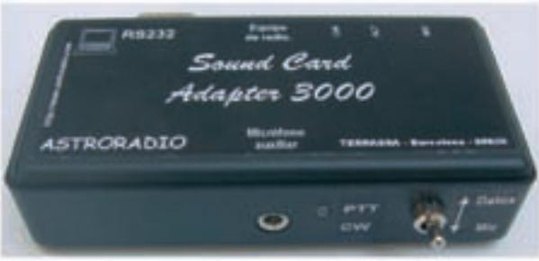
El nuevo Sound card adapter 3000 USB incluye como mejoras salida para keyer para su uso en CW y una entrada para un micrófono auxiliar que permite la conmutación rápida entre la señal de audio del TRX y un micrófono lo que puede ser muy útil en la operación con los programas echolink, eqso etc..
