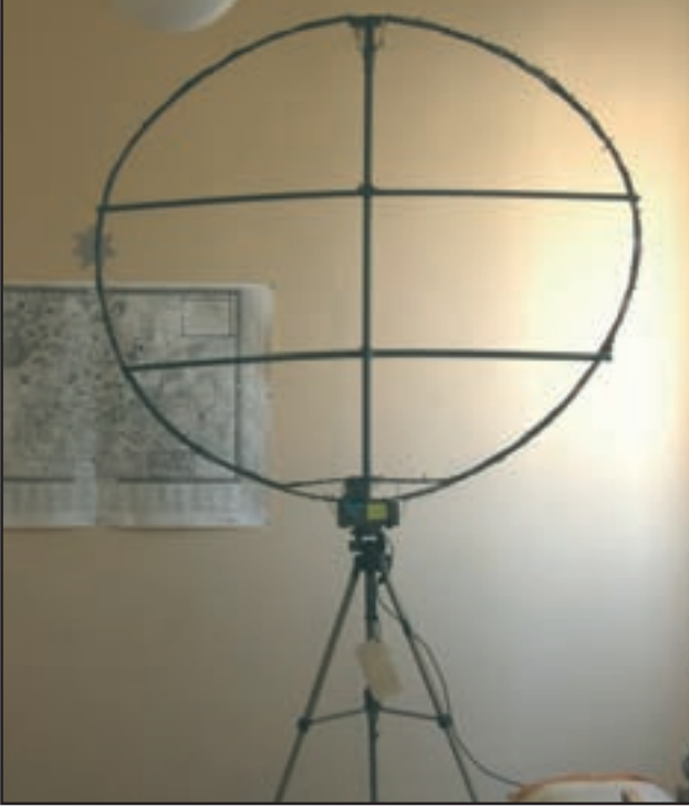
Foto B: Un Loop direccional. Este tiene una anchura de 1,30 metros, pero las dimensiones y forma final podrán variar dependiendo de las disponibilidades de espacio o de la imaginación del operador. El condensador sintoniza desde 300 hasta 2000 kilohertzios, pero la antena en sí, aun funcionando sin sintonizar, conserva ciertas prestaciones en el rango de 150 kHz hasta bastante entrada la Onda Corta.
