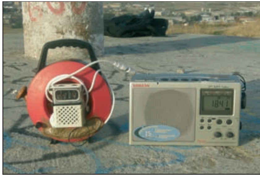
Foto C: Bobina para transportar cómodamente un cable de teléfono de 25 metros de longitud y desplegarlo tranquilamente en el campo. El viejo "transistor" portátil hace las funciones de "acoplador" entre la antena y el moderno receptor de Onda Media, pudiendo usarse incluso parte de sus componentes como atenuador para que los armónicos de estaciones de Onda Corta no hagan su presencia. Como en el caso anterior, con cada modelo de receptor tendremos posibilidades de experimentación diferentes.
