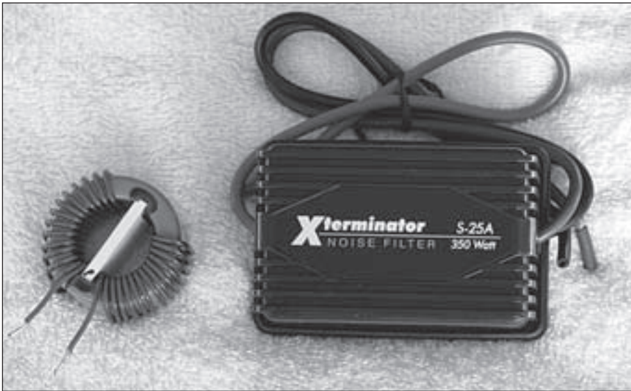
Foto C.- Un choque que puede ser utilizado para filtrar la corriente continua y minimizar el ruido generado en el vehículo. Un modelo comercial seguro que será un filtro más elegante para instalar en la línea de 12 V. Pide a tu tienda de equipos de radio que te recomiende uno.
