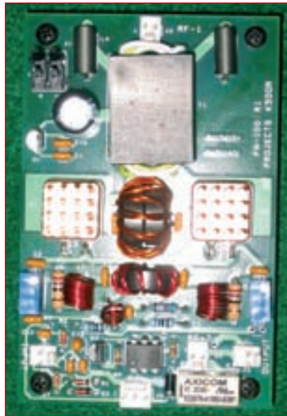
Foto C.- El PA-100 es un amplificador QRP en kit para las bandas de 160 a 10 metros; con una potencia de entrada de 100 milivatios proporciona 5 vatios de salida.
