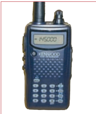
El robusto TH-K2, un portátil de Kenwood para 2 m que puede ser programado por medio de un ordenador y que sigue funcionando incluso cuando se cambia la batería.
