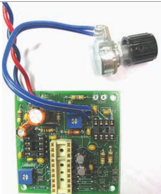
Foto C. El filtro de audio conmutado capacitivo del club NEQRP. Es un kit que no es difícil de montar y cuyos componentes contemplas aquí. Aproximadamente son tres docenas. Necesitas añadir conectores de entrada/salida y una batería de 9 o 12 V. El filtro puede conectarse al conector de altavoz o auriculares de cualquier receptor o transceptor y permite reducir el ancho de banda pasante desde 1500 hasta 60 Hz. (Foto cedidas por Dennis Marandos, K1LGQ).
