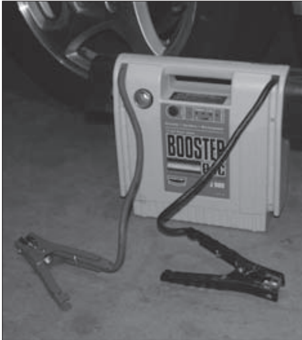
Foto B.- Una batería con convertidor de tensión (13,8 V) que puede ser utilizada para alimentar un equipo temporalmente para hacer pruebas y ajustes. Hay que tener mucho cuidado en que no se cruce el terminal positivo con alguna masa.
