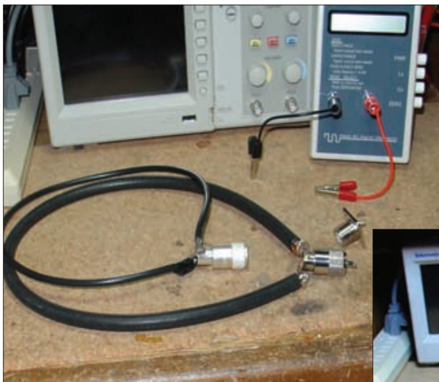
Foto D. Medida de la inductancia con unas cuantas ferritas
