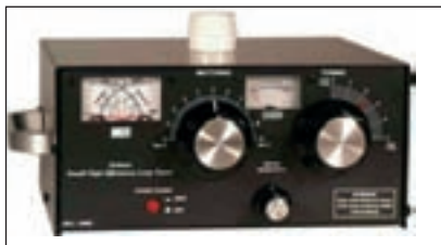
Foto D. Adaptador de impedancias de alto rendimiento MFJ-936B para antenas de aro; permite operar en las bandas de 3,5 a 29,7 MHz con una potencia máxima de 150 vatios, sin necesidad de radiales u otro plano de tierra, desde ubicaciones con serias restricciones de espacio.
