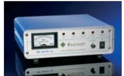
Foto C. Transversor de altas prestaciones TR144H +40 de Kuhne Electronics; a partir de un transceptor que cubra el segmento de 28 a 30 MHz, permite operar en la banda de 144 a 146 MHz, con unas notables prestaciones en recepción, con una potencia emitida de hasta 25 vatios.
