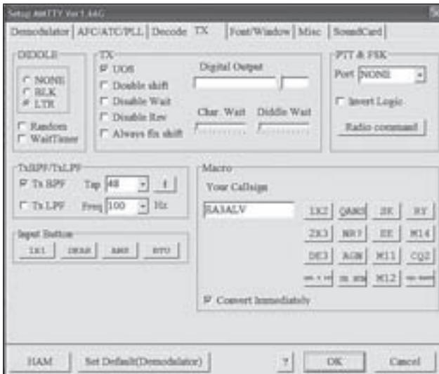
Figura 4. Pantalla de configuración que aparece al clicar sobre la pestaña TX de la pantalla de configuración. En ella se puede especificar un puerto para la señal PTT y FSK y entrar el indicativo propio que se usará por omisión.
