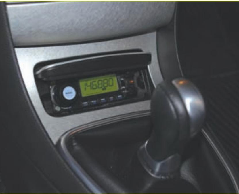
Foto I. Desmonté el compartimento del cenicero y mechero de la consola central, para instalar el panel de control del transceptor.
