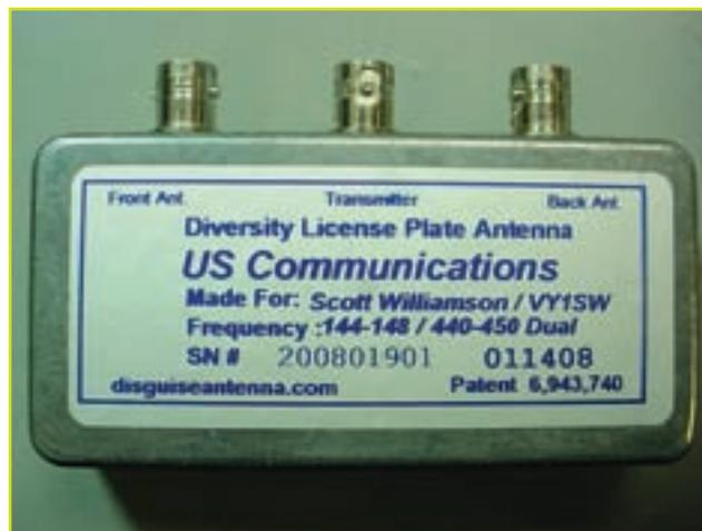
Foto B. Caja de control de diversidad de US Communications para la antena "placa de matrícula".
