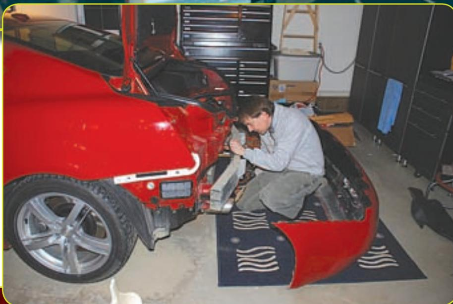
Foto D. Haciendo pasar el cable que forma la antena a través de una arandela de goma, tras la espuma del parachoques.
