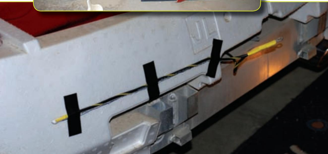
Foto E. Hilo de contraantena; grabé una ranura en la espuma para que el cable no sobresaliera.
