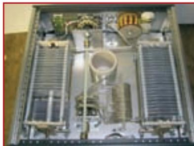
Foto B. Interior del adaptador de antena de construcción artesanal *LAMCO DU-1500* (ver texto). Es patente la calidad de los componentes y de la construcción.
