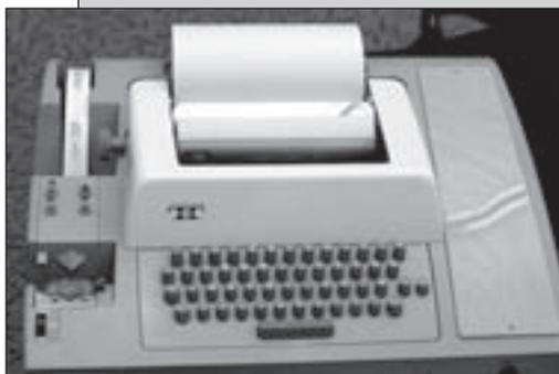
Con máquinas similares a ésta, y que usó como consola terminal de miniordenadores, los aficionados al RTTY en los "tiempos heroicos" descodificaban y generaban sus señales, tecleando sus mensajes o usando cintas perforadas en vez de las "macros" actuales.
