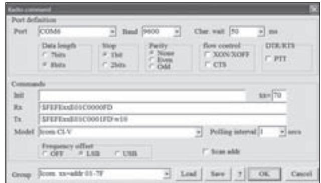
Figura 5. Pantalla de configuración de los comandos de la radio. En ella se determina el puerto que se usará para el CAT, el modelo de radio y el offset de frecuencia que usará el programa para calcular la frecuencia real de transmisión.
