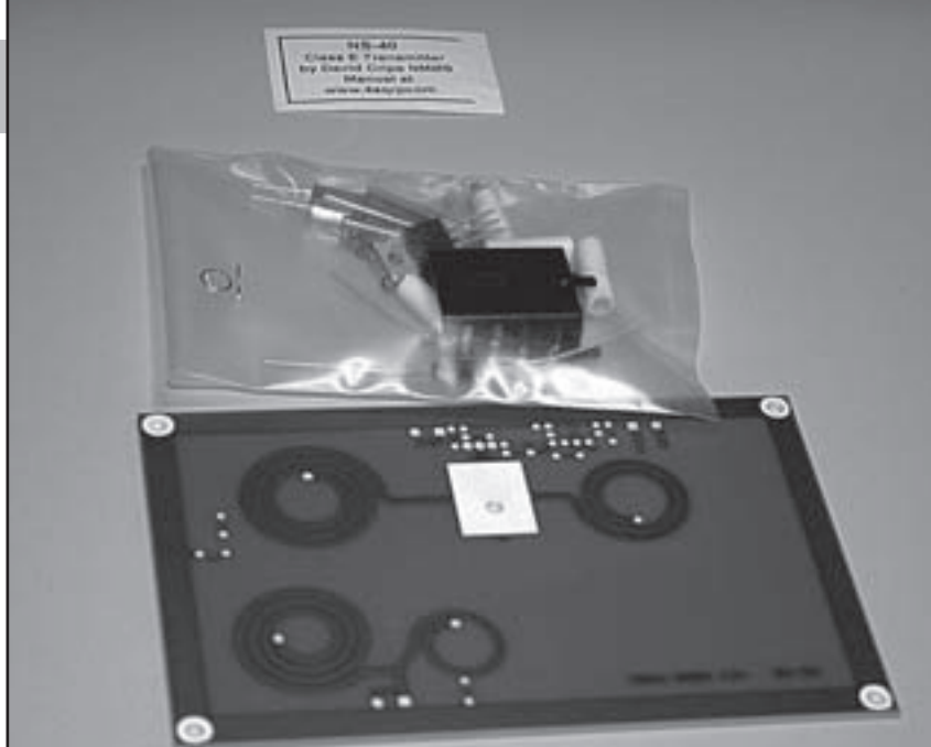
Foto - 4 El kit del transmisor QRP NS-40 tal como se envía para su montaje. El kit consta solamente de 14 componentes, pero no te creas que es algo demasiado sencillo. Contiene la más alta tecnología actual en diseño y un complejo cálculo matemático que da como resultado un diseño que con un rendimiento energético del 90%. (Fotos del NS-40 y de la figura 1 cedidas por Jay Bromley, W5JAY y su XYL Kathy, WQ5T).
