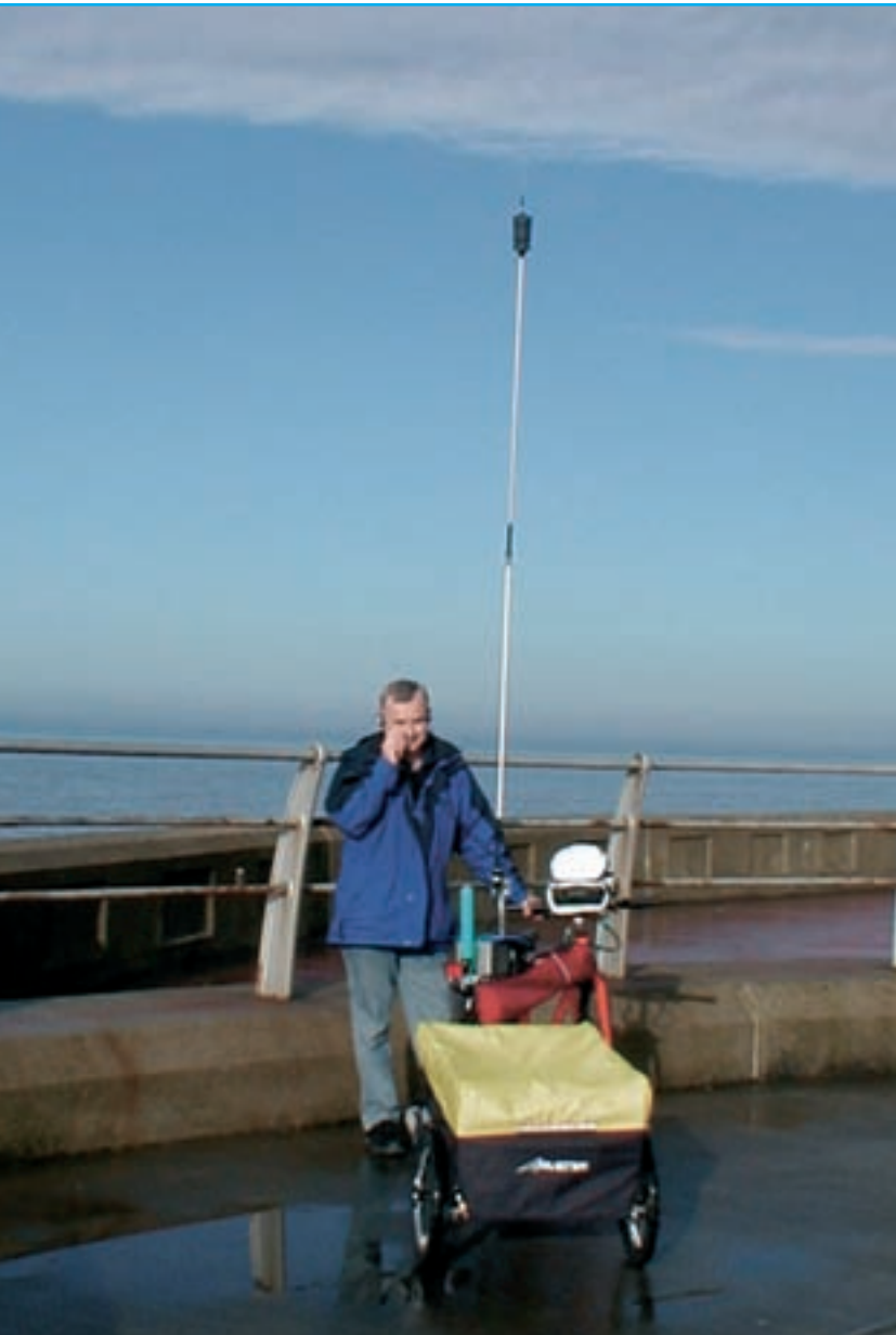
Foto 1. Este es David Starkie, G4AKC, con su instalación de "móvil bici" cerca de un muro en la costa inglesa. David dice que la proximidad del agua salada proporciona a sus señales un "empuje" similar al de una estación doméstica. Usando su combinación de 50 W (ver texto), ha trabajado estaciones de todo el mundo. (Fotos 1, 2 y 3 cortesía de G4AKC)
