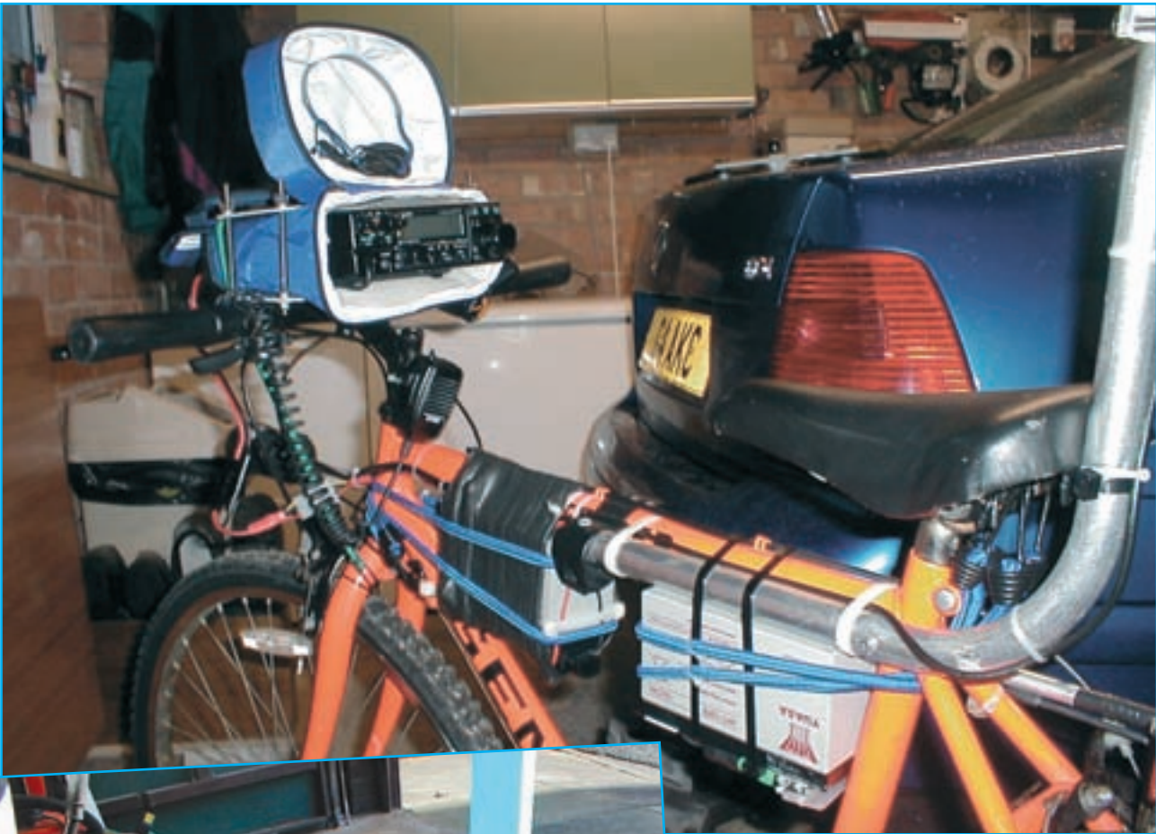
Foto 2. Vista en el garaje de la bicicleta de G4AKC, con el Alinco DX-70 encajado en una bolsa sobre el manillar, con una tapa a cremallera para protegerlo de la intemperie. La circulación de aire en la bolsa es limitada, pero usando la radio a sólo 50W como máximo no se calienta demasiado.
