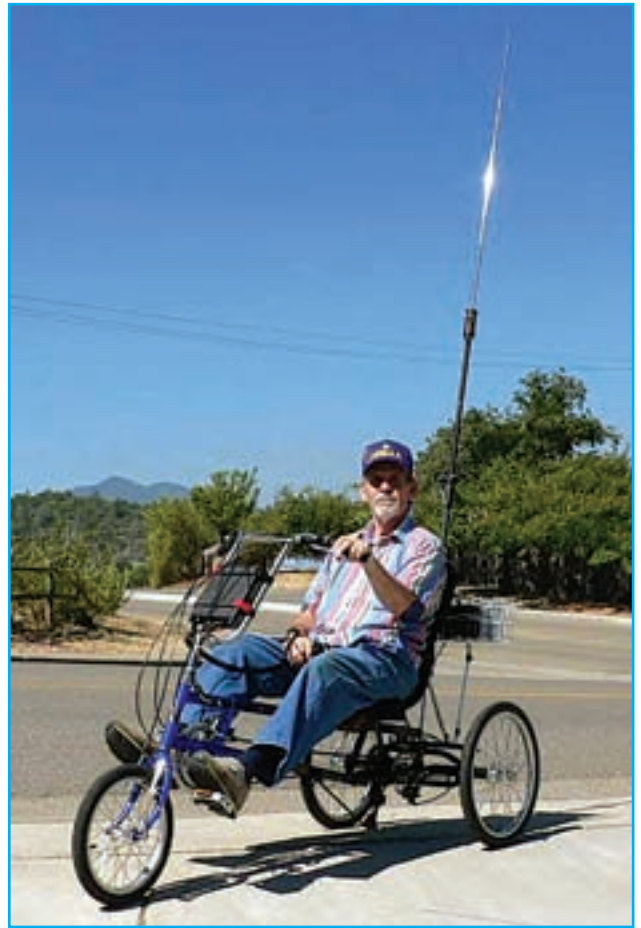
Foto 5. Este triciclo, a bordo del cual rueda Ed Belluso, NN6AA, cierra la revista de esta clase. Su equipo consiste en un IC-703, con 10 W de salida y una antena Buddstick. Una batería de 18 A/h debajo del asiento le asegura el funcionamiento durante todo el fin de semana. Es una realización inteligente para gozar pacíficamente de la radio cuando las limitaciones vecinales no te dejan otra salida. (Foto cortesía de NN6AA)
