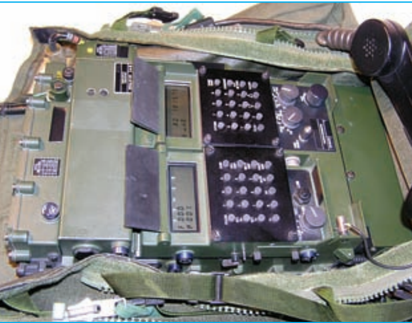
Foto 8. Vista en detalle del equipo militar británico de mochila PRC-319. Es un transceptor portátil que saca 50 W y cubre desde 1,5 hasta 40 MHz, con un peso de unos 10 kg.
