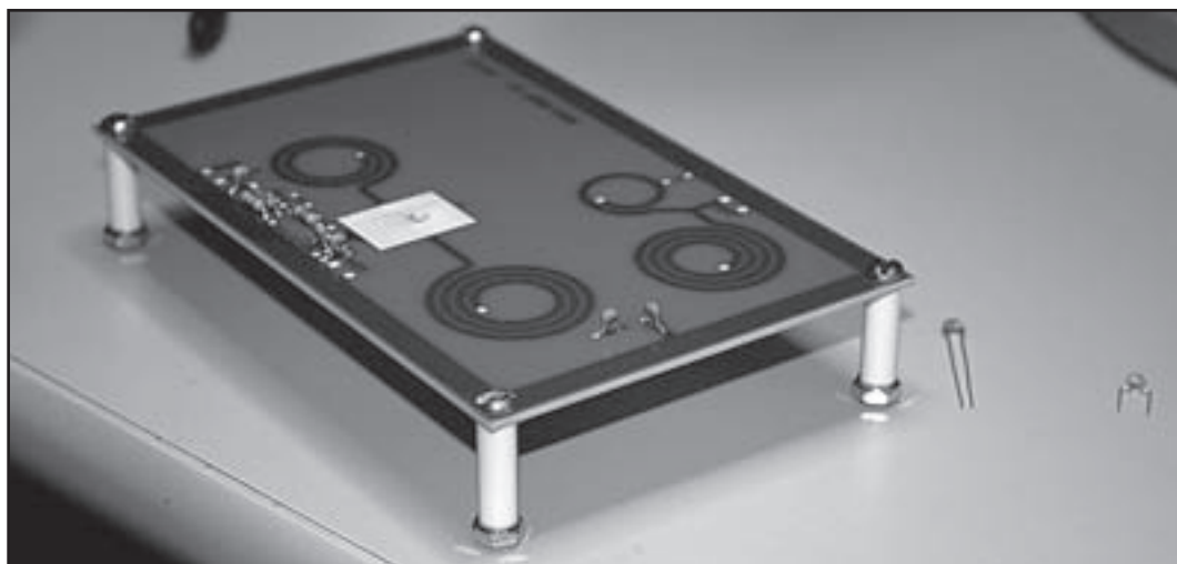
Foto - 4 Este kit del NS-40 se monta en 10 o 15 minutos y muestra los 7 condensadores y las 3 resistencias necesarias, aparte de los 2 transistores, el cristal y los cables de conexión externa. Observa que no lleva ninguna bobina. Están impresas en la placa del circuito y tienen una inductancia suficientemente precisa, que constituyen un nuevo y excelente diseño.
