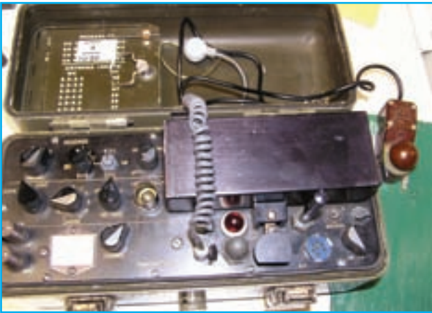
Foto 10. Vista en detalle del transceptor PCR.64. Las baterías van instaladas en el fondo, el cable de la antena y el manipulador se alojan en el compartimiento superior. El pequeño equipo se adapta fácilmente para operar en 40 metros y es una pequeña joya, bastante escasa.
