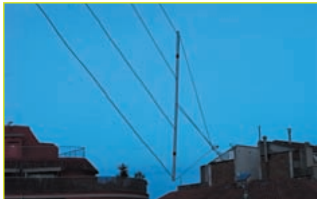
Foto C. Detalle de uno de los extremos de la antena "Charli", con su espaciador de PVC y el juego de tensores.
