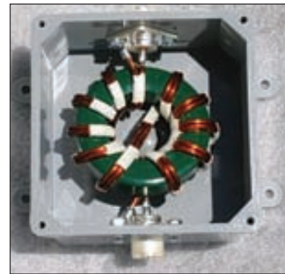
Foto E. Interior del balun de corriente relación 1:1, modelo 1113u de Balun Designs LLC .
