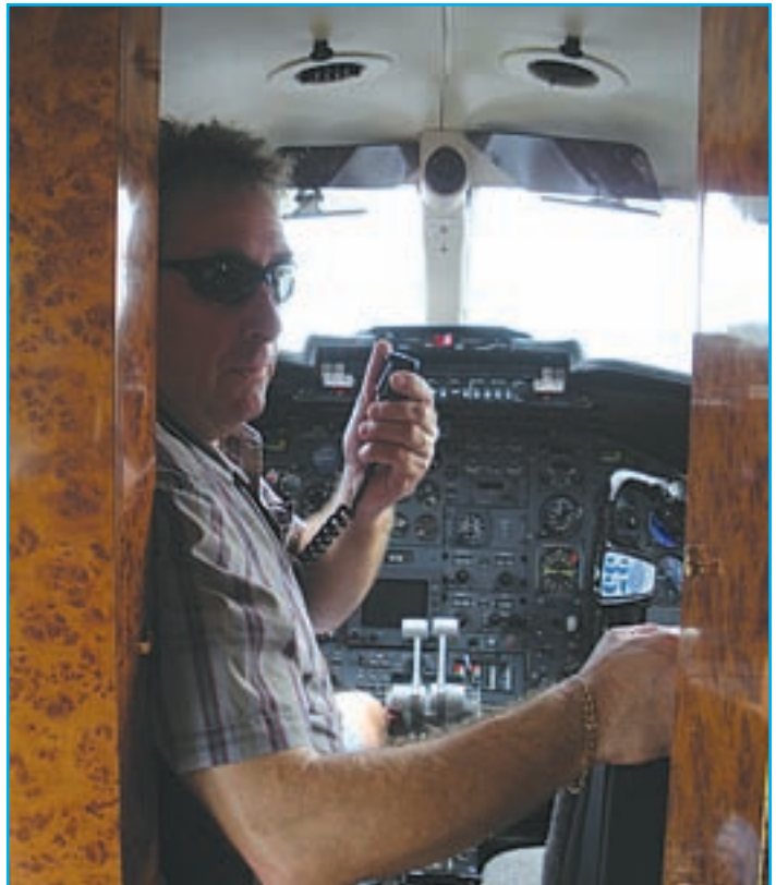
Foto 3. Joey en la carlinga, operando como N4ZUW/ma. El equipo es un transceptor comercial de 100 W en HF con acoplador automático, incluido entre los equipos de a bordo. La antena es una hilo tendido entre un ala y la cola.
