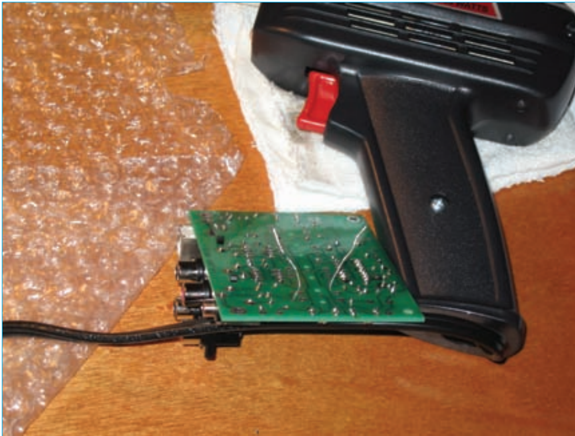
Foto C. Doblar un poco los rabillos de los componentes ayuda a sujetarlos.
