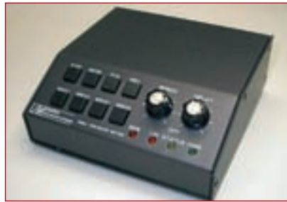
Foto D. Manipulador de memorias de voz y CW VK-64 de Unified Microsystems.
