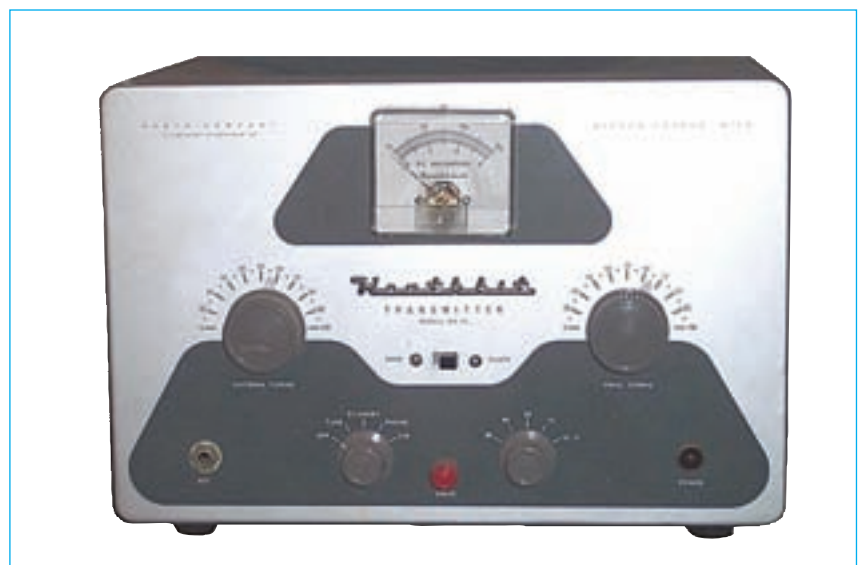
Foto A. Aspecto final del kit DX-40, completamente montado. (Foto cortesía de RigPix.com)
