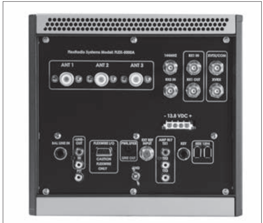
El panel posterior del FLEX-5000 está equipado con un conjunto de conectores que permiten su interconexión, además de con diversas antenas y el ordenador, con accesorios opciones para mayor facilidad de operación
