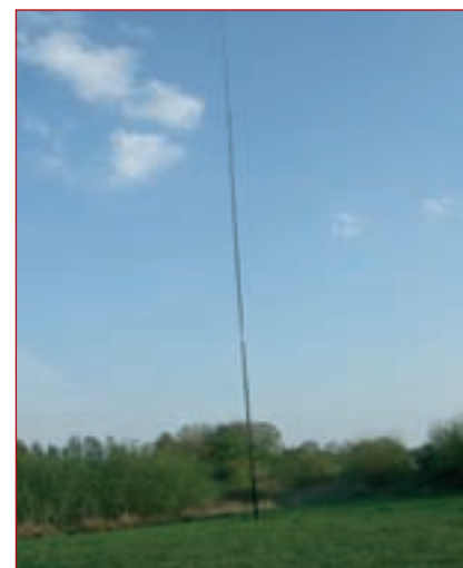
Foto E. Nuevo mástil telescópico de 26 metros de alto de Spiderbeam, durante las pruebas de varios meses en la costa del mar Báltico; soportó todas las tormentas. En la foto de alta resolución se observan tres juegos de vientos (el modelo de 18 metros requiere dos).
