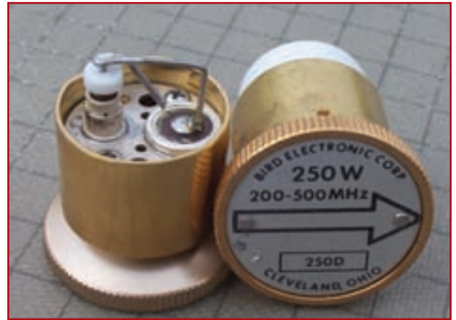
Foto E. Un mismo tapón enchufable Bird que sirve tanto para medir la potencia directa como la reflejada.
