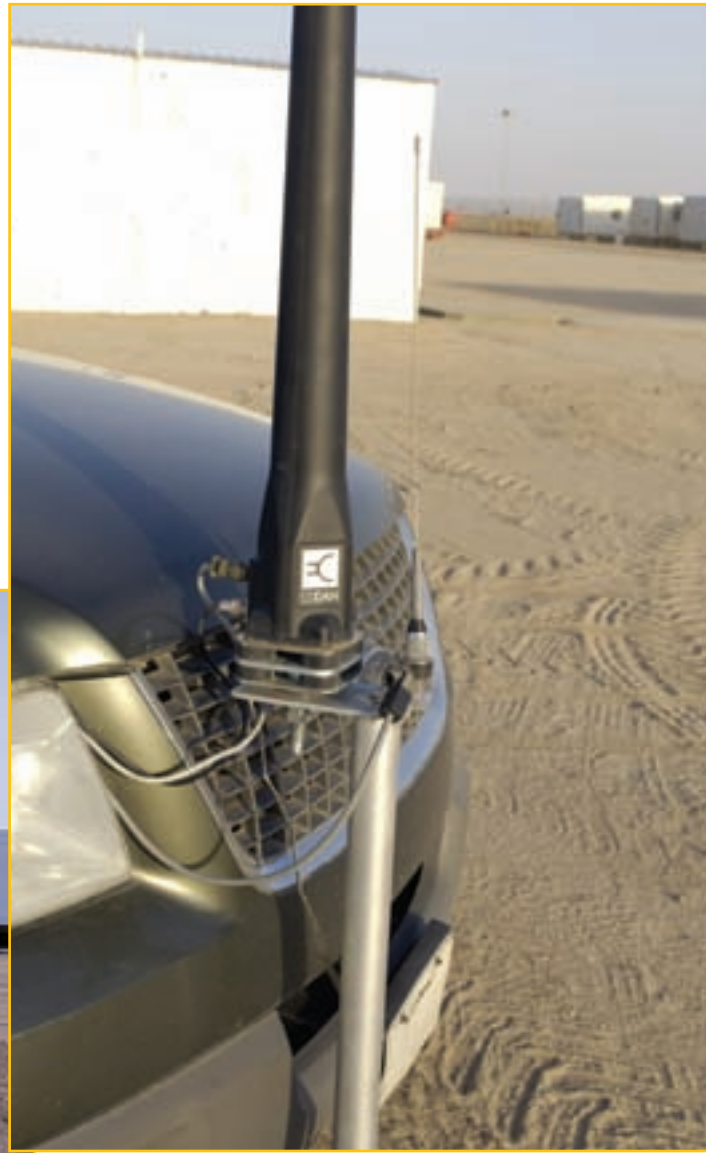
Vista en detalle de la base de la antena Codan 9350, montada en el parte delantera del Ford.
