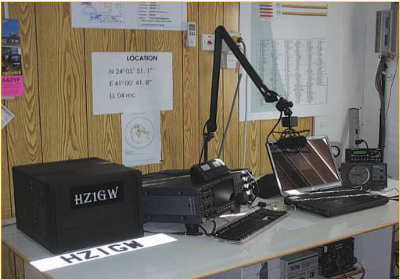
El cuarto de radio de HZ1GW, cerca de la ciudad de Medina, en Arabia Saudita, equipa un transceptor IC-7800, un amplificador IC-PW1 y un micrófono Heil PR-781, además de otros accesorios.
