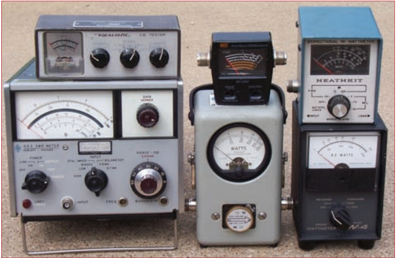
Foto A. Medidores de ROE de todo tipo, precios, calidad y precisión. ¿Qué precisión tiene el tuyo?
