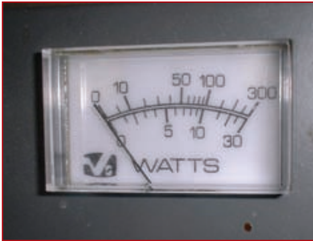
Foto D. La escala de un típico medidor de ROE. Obsérvese que no es lineal.
