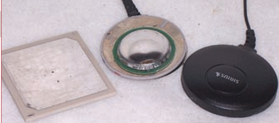
Foto G. Antenas de panel regular (rectangular) y para la cadena Sirius (redonda). Observa el grueso del panel y la ranura en el plano de tierra magnético de la antena para Sirius.
