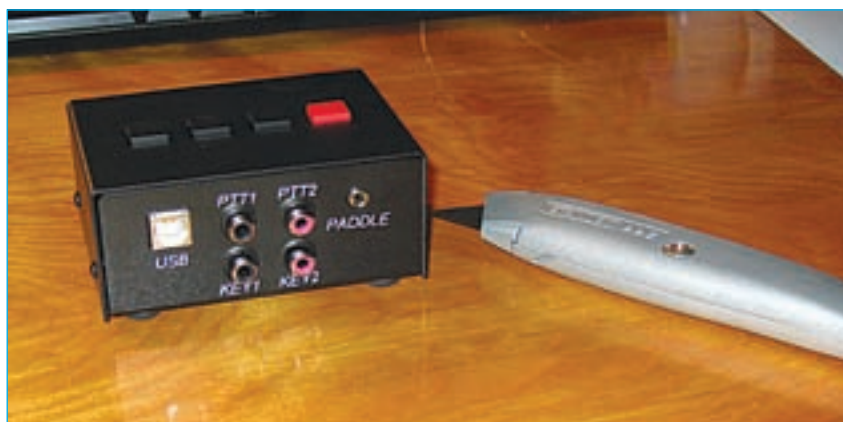
Foto E. Vista posterior del manipulador WKUSB. Véase el zócalo de la interfaz USB.
