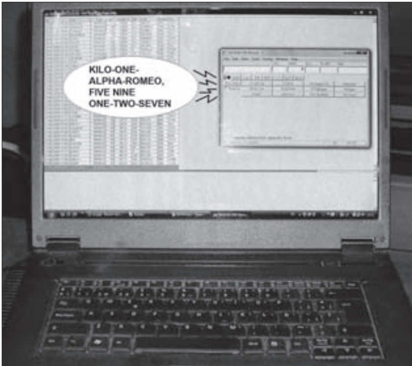
Foto A. N1MM Logger permite emitir en fonía mensajes pregrabados, los indicativos de los correspondientes y números progresivos.
