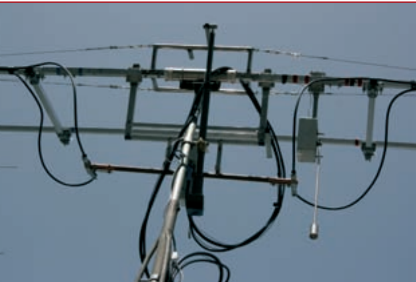
Foto 3. Vista en detalle del sistema de enfaseo de las 4 antenas de 144 MHz y el péndulo indicador de elevación.
