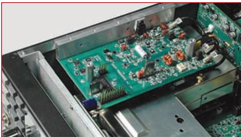
Foto G. El módulo interno para 2 metros K144XV de Elecraft montado en el interior de un transceptor K3.
