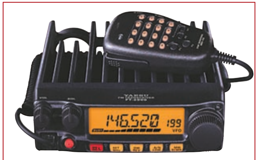
Foto F. El nuevo equipo móvil de Yaesu FT-2900R que da 75 vatios de salida.
