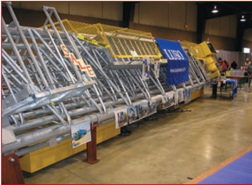
Foto N. El impresionante mastodonte de más de 13 toneladas era difícil de que pasara desapercibido en un rincón. La torreta LUSO150US de Luso autoportante y telescópica se extiende hasta 45 metros de altura y puede soportar hasta 265 kilos de antenas.
