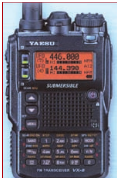
Foto E. El portátil de Yaesu para 50/144/222/430 MHz.
