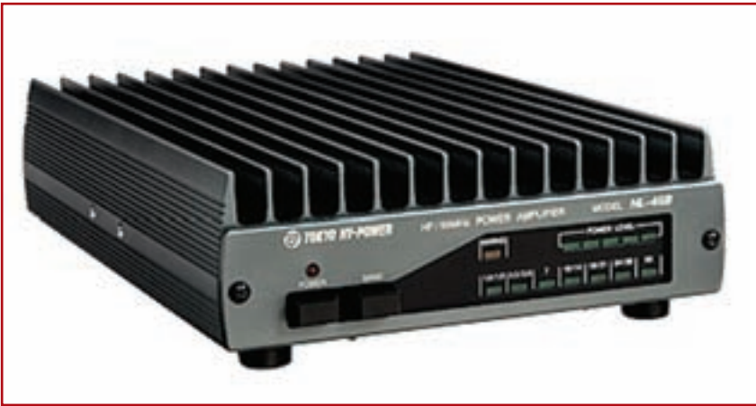
Foto K. El nuevo amplificador lineal HL-45B de Tokyo Hy-Power ha sido diseñado para amplificar los 5 W del FT-617 de Yaesu, pero también puede funcionar con otros equipos QRP, dando 45 vatios de salida con 5 W de excitación entre 1,8 y 50 MHz.
