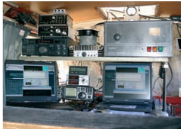
Foto 5. Operando en 70 cm, el único cambio apreciable en la configuración de la mesa de trabajo es el amplificador y el vatímetro.
