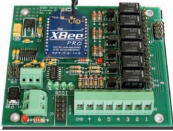
Foto G. Green Heron Engineering presenta un controlador sin hilos para manejar desde la estación los relés de conmutación de antenas en lo alto de la torreta sin necesidad de múltiples bajadas. Esta placa es el corazón del sistema y va montado en una caja estanca.
