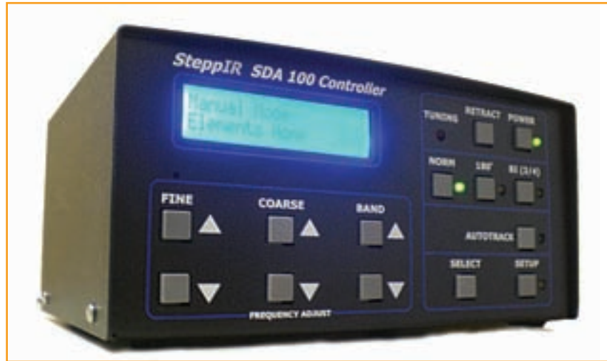
Foto C. El nuevo controlador SDA-100 de las antenas de SteppIR dispone de una pantalla LCD mayor que la de los anteriores, así como unos indicadores LED de dirección y de la sintonía de la antena, entre otras prestaciones.
