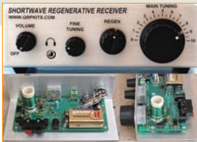
Foto Q. El Scout Regen Receiver de Hendricks QRP Kits es un sencillo receptor regenerativo de dos bandas para montar en kit.
