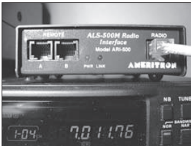
Foto E. El ARI-500 sobre el transceptor del autor. Si se usa, el control remoto ALS-500RC se conecta a la toma REMOTE A.
