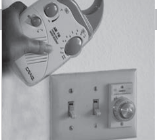
Foto C. Un receptor de radio corriente con AM nos puede servir para localizar una interferencia electromagnética. Sintoniza la radio a una frecuencia libre y escucha el zumbido de la interferencia. Mueve el receptor de derecha a izquierda y sigue la dirección en la que el ruido parece ser más fuerte.
