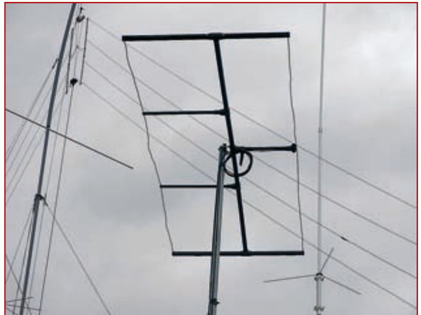
Foto A. Antena Moxon para la banda de 6 metros, lista para operar.
