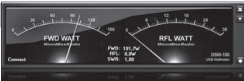
Foto B. El DSW-150 es un conmutador TX/RX automático, que mediante una conexión USB presenta en la pantalla del ordenador un vatímetro (hasta 150 W) y medidor de ROE virtuales.
