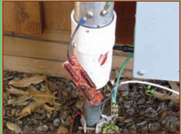
Foto B. Tres resistencias de 3 M \Omega en serie montadas en una placa perforada en la base de la antena vertical de 13 metros del autor.
