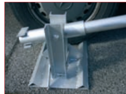
Foto D. Base para mástil abatible para anclaje bajo la rueda de un vehículo. Permite que una sola persona levante fácilmente un mástil de hasta 10 kilogramos de peso.
