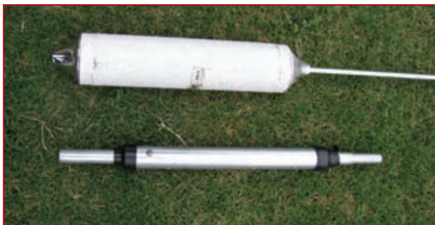
Fotos A y B.- Algunos ejemplos de trampas utilizadas en antenas. Normalmente se componen de bobinas y condensadores de todos tipos.
