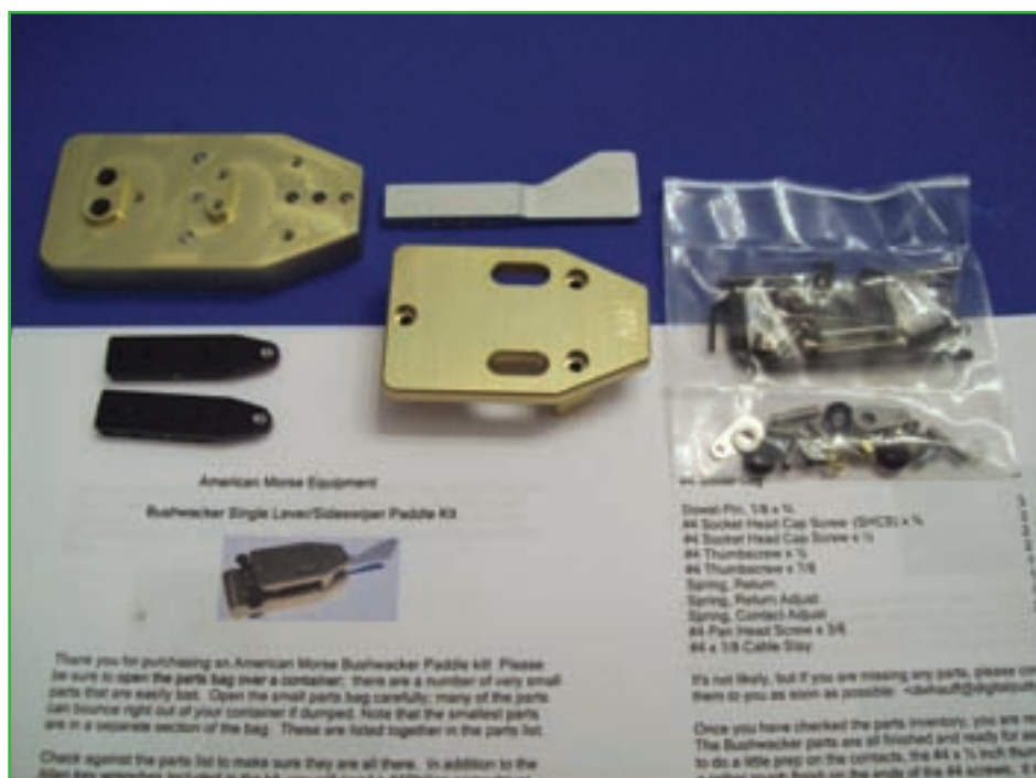
Foto C. Este es el kit del nuevo manipulador lateral de pala única Bushwhacker tal como fue recibido, procedente de W6AME de www.americanmorse.com desplegado y listo para comenzar el montaje. Todos los componentes han sido finamente pulidos y acabados, de forma que todo lo que tienes que hacer es atornillarlo todo y hacer los ajustes finales según tus preferencias.
