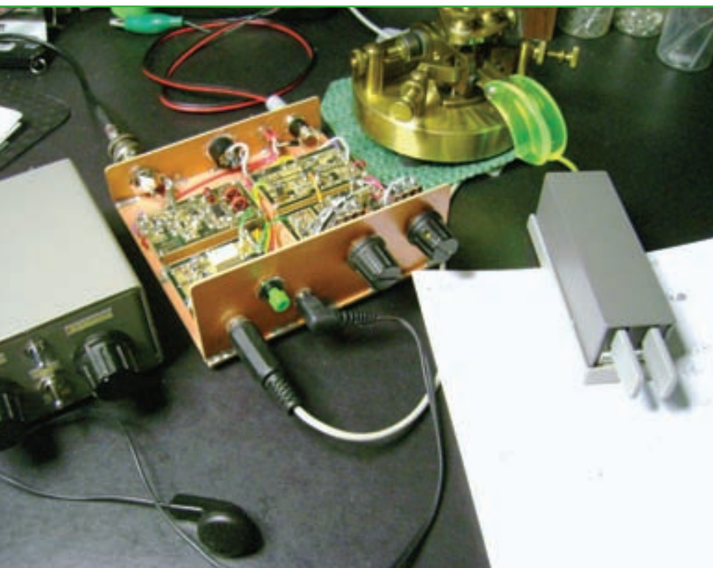
Foto H. El transceptor SMD de W5SUJ operando en 40 metros. El mini-equipos opera complementado por un acoplador de antena BLT de <qrpkits.com> (a la izquierda) manejado con un manipulador R3A sobre una base redonda de J.M. March, K4QU (ver <www.qsl.net/k4ku>); y otro de Palm Radio en el lado inferior derecho de MorseX.com.
