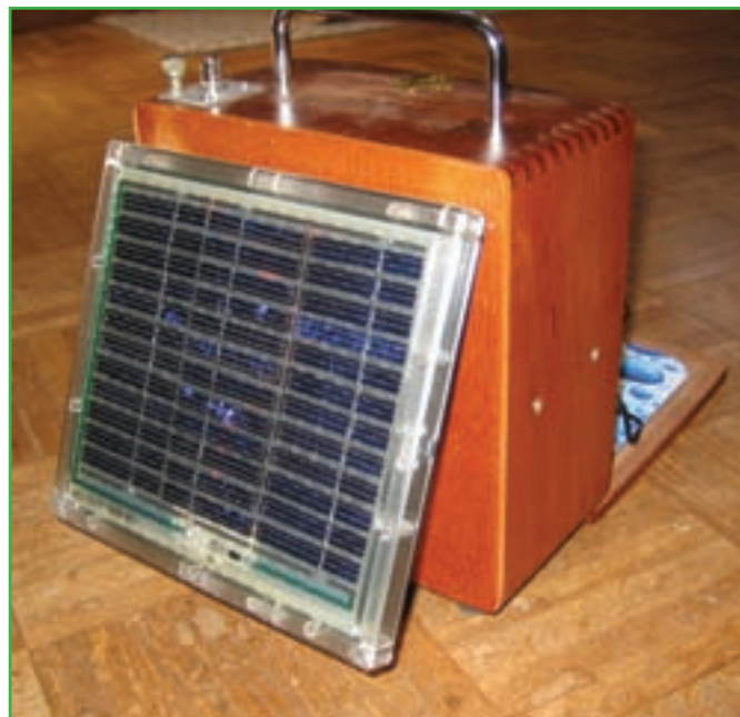
Foto B. Aquí tienes la caja de puros de NV1X lista para viajar y recargándose la batería con un panel solar. Este montaje es energéticamente tan eficiente que merecería estar pintado de verde.
