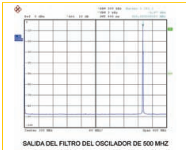
Figura 1. Gráfica de analizador de espectro mostrando la limpieza de la señal de salida del oscilador a 500 MHz del DDS R-4C.
