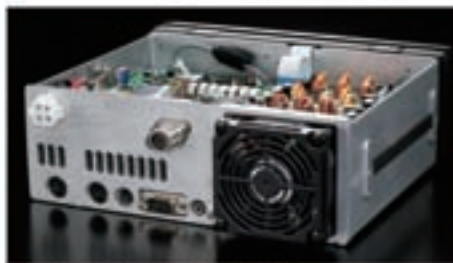
Chasis en fundición de aluminio con ventilador
