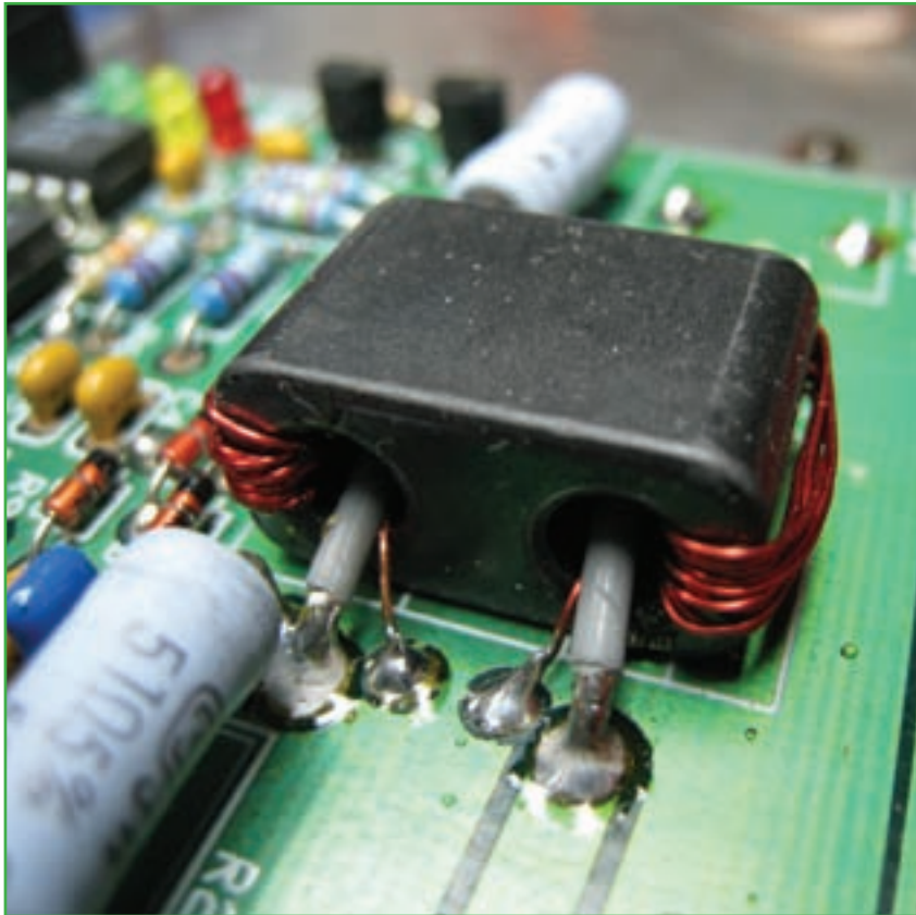
Foto A. Toroide tipo "binocular". Es más fácil de bobinar de lo que parece.
