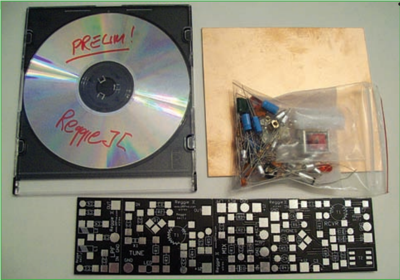
Foto E. El nuevo kit del minitransceptor Regie II, tal como fue recibido procedente de W1REX < www.QRPme.com >. Debes empezar por montar las cuatro placas y clasificar los componentes en cuatro bolsitas, una para cada placa. Las instrucciones para su montaje vienen en un CD con el kit.
