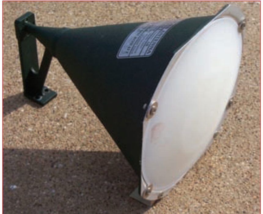
Foto A. Antena de bocina dieléctrica para 76 GHz.
