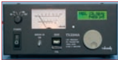
Foto A. Transmisor Thamway TX2200A para la banda de 136 kHz; opera en CW y entrega hasta 100 vatios en el margen entre 135,7 y 137,8 kHz (fuente: Thamway).
