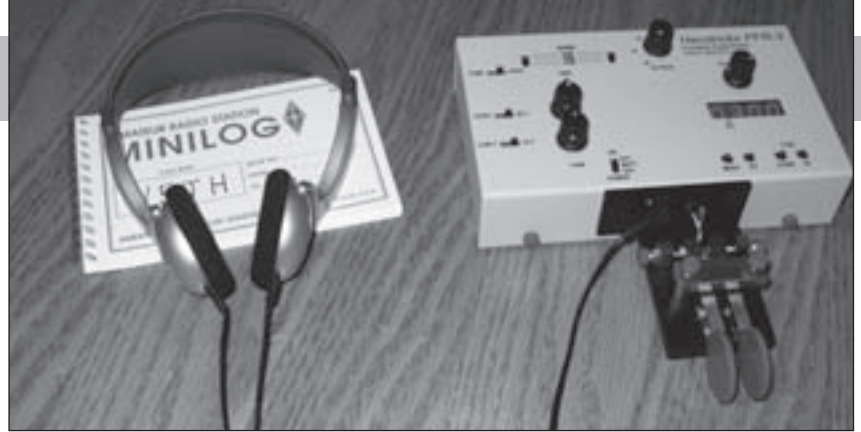
Foto H. Aquí tienes montado el kit del manipulador lateral de palas Baby Black Widow de W5JH colocado al frente de un transceptor QRP, concretamente PFR-3 preparado para su utilización. El manipulador puede ser utilizado por sí mismo para operar con cualquier transceptor (ver detalles en el texto).
