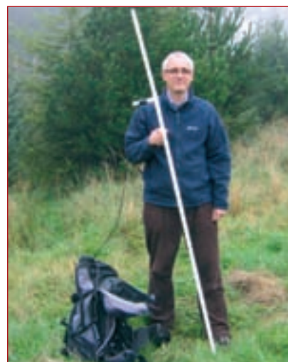
Foto D. Antena MFD de SOTA Beams para operación portable en la banda de 2 metros (fuente: SOTA Beams).
