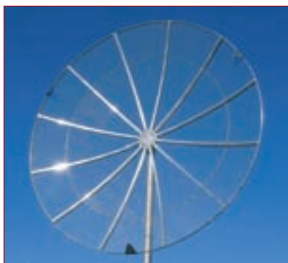
Foto C. Reflector parabólico de 1,5 metros de diámetro de RF HAMDESIGN. Puede ser empleado por ejemplo en las bandas de aficionado de 1,2 GHz (22,2 dBd de ganancia), 2,3 GHz (27,2 dBd), 3,4 GHz (30,3 dBd) y 5,7 GHz (33,9 dBd). Incluye conector tipo N que soporta hasta 1000 vatios. En la imagen se muestra sin alimentador (fuente: RF HAMDESIGN).
