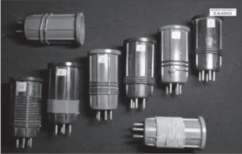
Foto G. La posibilidad de recibir y transmitir en varias bandas con los equipos caseros de la época se facilitaba mediante el uso de bobinas intercambiables como las de la fotografía.
