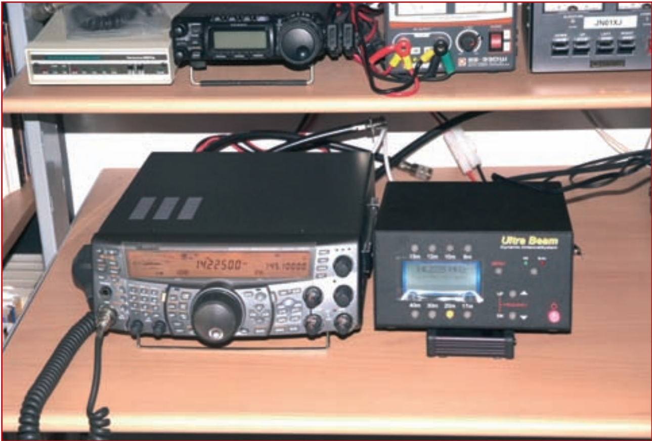
Foto B. La caja controladora del sistema UltraBeam, instalada junto a un transceptor Kenwood TS-2000. La antena ha quedado automáticamente sintonizada a la frecuencia de 14.225,00 kHz.
