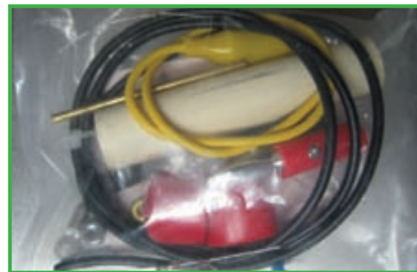
Foto D. La punta de prueba detectora de RF en kit, mostrando los escasos componentes que la hacen muy fácil de montar.
