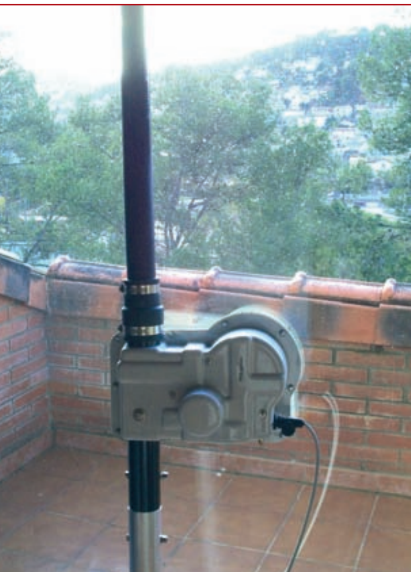
Foto C. Base de la antena Ultrabram V-6-20, mostrando la unidad motriz, montada sobre el tubo de acero inoxidable y soportando la primera sección del tubo de PVC por el que se desliza la cinta de cobre del radiador.
