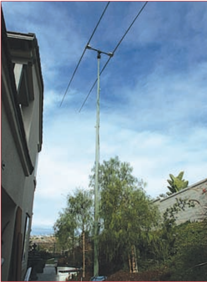
Foto E. Un par de minutos más tarde, la directiva SteppIR se levanta hasta 15 metros de altura (una magnífica joya, ¿no crees?) y la vertical de 10 metros de altura se encuentra ya abatida y fuera de vistas.
