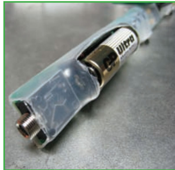
Foto B. Vista del extremo posterior del inyector/trazador con la pila y el jack de auriculares.
