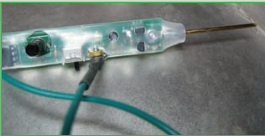
Foto C. La punta del inyector/trazador con el control de volumen y el interruptor (junto al cable).
