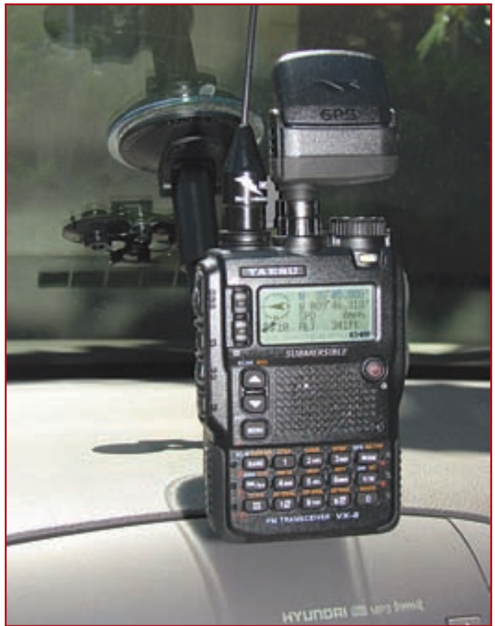
Foto B. El VX-8DR puede ser fijado al parabrisa mediante un conjunto de succión, igual que un típico receptor GPS (como en realidad, es). Mediante Bluetooth, podemos operar la radio en modo manos libres.
