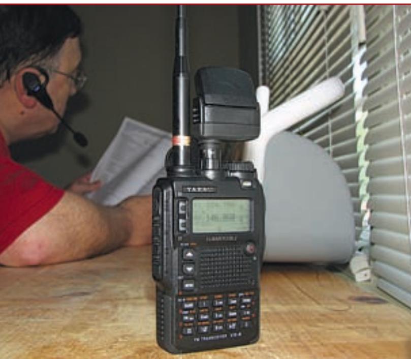
Foto C. Una manera de usar Bluetooth en casa con el VX-8DR es situar la radio cerca de una ventana donde sea óptima la recepción de un repetidor, mientras monitorizamos el canal mediante un casco-micrófono Bluetooth.
