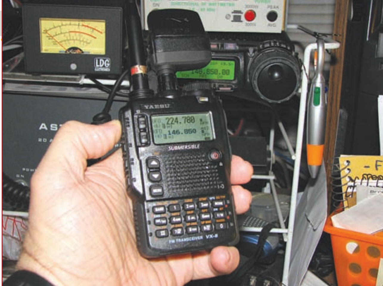
Foto A. Con su antena GPS, sostenido por un estribo especial, el VX-8DR iguala literalmente a un equipo de sobremesa preparado para la tecnología APRS (Fotos del autor)
