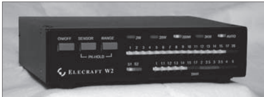
Foto D.- El nuevo vatímetro W2 de Elecraft cubre el margen de potencias entre 2 y 2000 W y las bandas de HF, 6 metros y 144-450 MHz. (Foto cortesía de Elecraft, Inc.)
