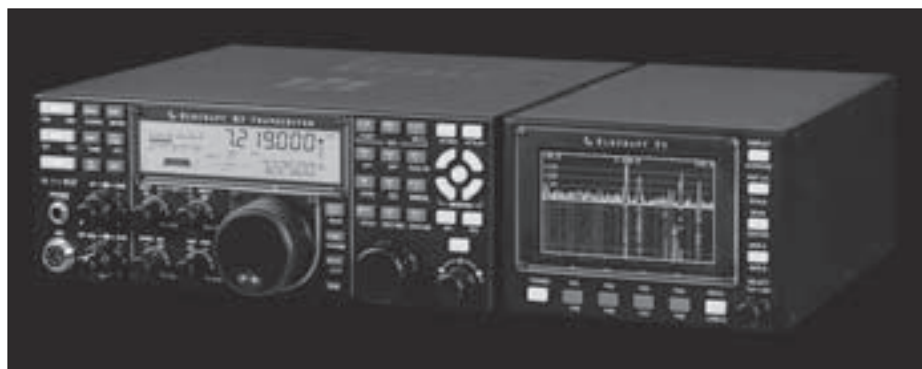
Foto E.- El adaptador panorámico Pandapter P3 de Elecraft, bajo tecnología DSP proporciona al K3 una visión panorámica de hasta 200 kHz de la banda. (Foto cortesía de Elecraft, Inc.)
