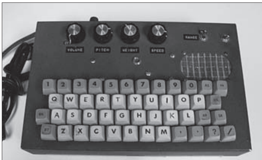
Foto A. El teclado de Morse de K4KN de los años 70 tiene un buffer de un solo carácter y carece de barra espaciadora. Aún hoy es apreciado por muchos entusiastas del QRQ. (Foto cortesía de K8IF, vía <qrqcw.net.ning.com>)
