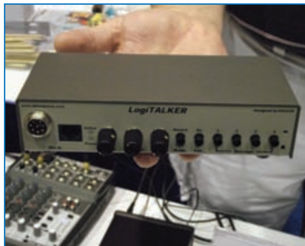
Foto D. El Logitalker de Idiom Press es un "loro" de 4 canales de memoria, disponible tanto en kit como montado.
