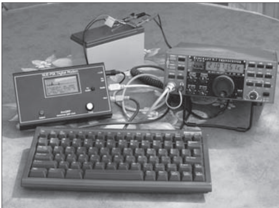
Foto F. El módem digital NUE-PSK conectado a un teclado, un transceptor K2 y a una batería que lo convierte en una estación digital portátil muy compacta.
