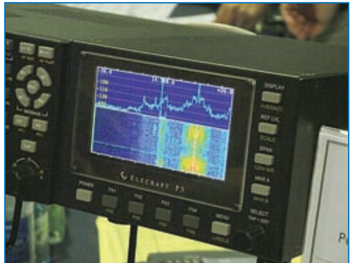
Foto L. El Panadapter P3 de Elecraft ha sido diseñado para el transceptor K3, pero también funcionará con otras muchas radios.
