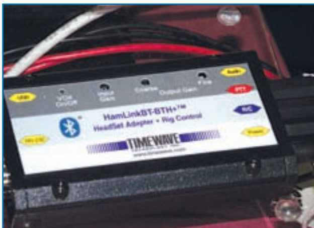
Foto K. La interfaz Ham Link BT-BTH de Time Wave Technology permite interconectar un ordenador personal con un puerto USB y un transceptor a través del conector de micrófono, permitiendo el control de muchas radios vía Bluetooth.
