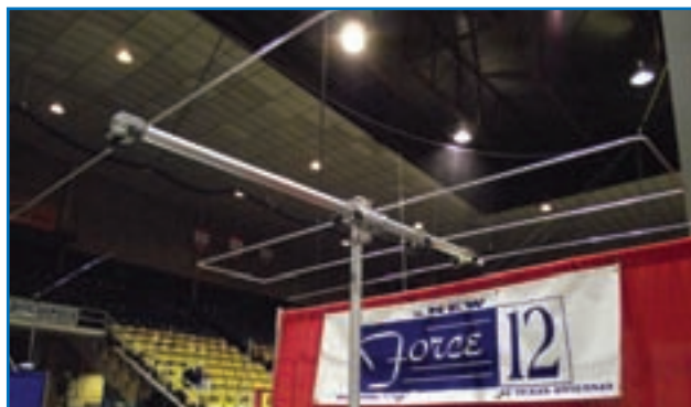
Foto G. Una antena direccional compacta para la banda de 6 metros de Force 12 Antennas.
