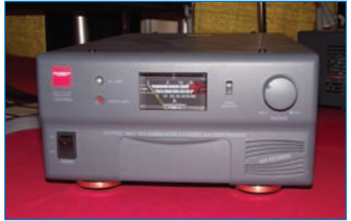
Foto O. Si tenemos necesidad de alta potencia, podemos considerar esta fuente conmutada de 60 A de RF Parts.
