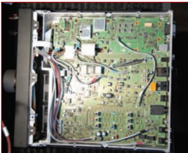
Figura 3. Vista interior del TS-590. Como en todos los transceptores modernos, casi todos los componentes son de montaje superficial.
