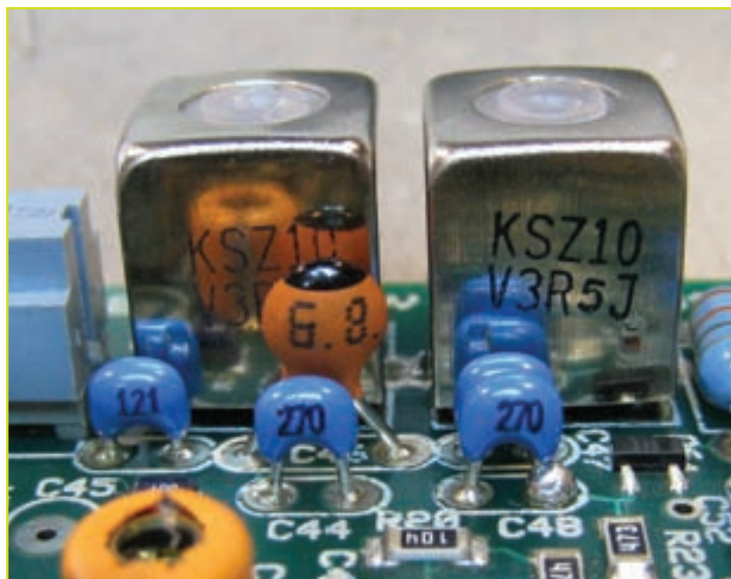
Foto C. Los condensadores deben colocarse con los códigos hacia el exterior de los componentes grandes para su más fácil identificación.
