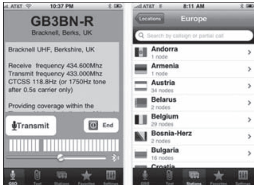
Figura 1. Dos ventanas de la aplicación gratuita para EchoLink sobre iPhone. Transforma un teléfono inteligente en una estación EchoLink totalmente funcional. (Imágenes cortesía de EchoLink).
