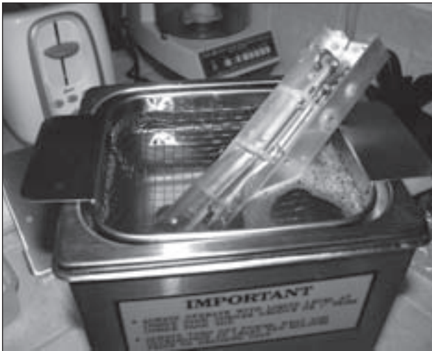
Foto 7 – Limpié el puente de ROE en la cubeta de ultrasonidos, un lado cada vez. Los conectores SO-239 estaban muy corroídos y salieron aún peor después del baño de 10 minutos con ultrasonidos, así que decidí reemplazarlos con unos nuevos. Después de haber limpiado el chasis y todos los componentes, empecé la reconstrucción. Se trataba de volver a montar el kit de nuevo.
