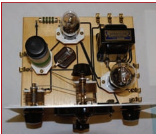
Foto E. No todos los equipos de radio en la AWA son antiguos. Louis Vermond, VE3BDV, construyó este regenerativo de 2 válvulas para 80 metros gracias a los planos de una edición del libro "Cómo ser Radioaficionado" de 1933.
