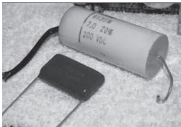
Foto 13 – Compárese el condensador viejo (en la parte superior) con un nuevo. Los componentes modernos son mucho más pequeños aunque su valor sea muy parecido.
