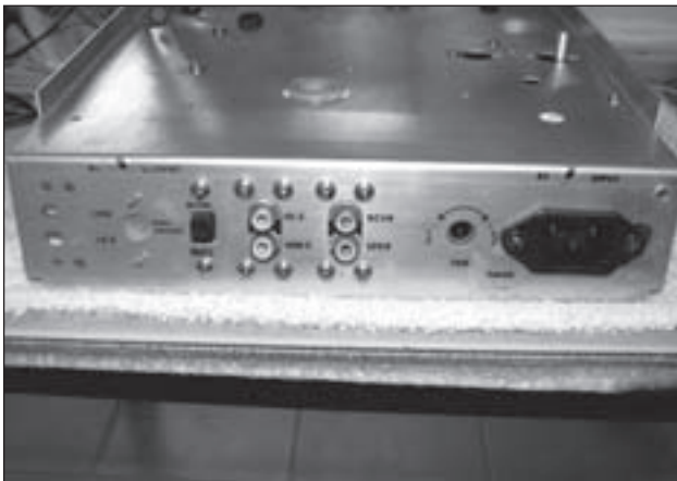
Foto 9 – Este conector de red no se fabricaba en 1966. Sin embargo, dispongo de un puñado de cables de red, de forma que modifiqué el chasis para instalarle uno apropiado. En esta imagen, se pueden ver también los nuevos tornillos que instalé en el panel posterior. Cambié todos los tornillos, arandelas y tuercas por unos nuevos, con cabeza de estrella y de acero inoxidable.
