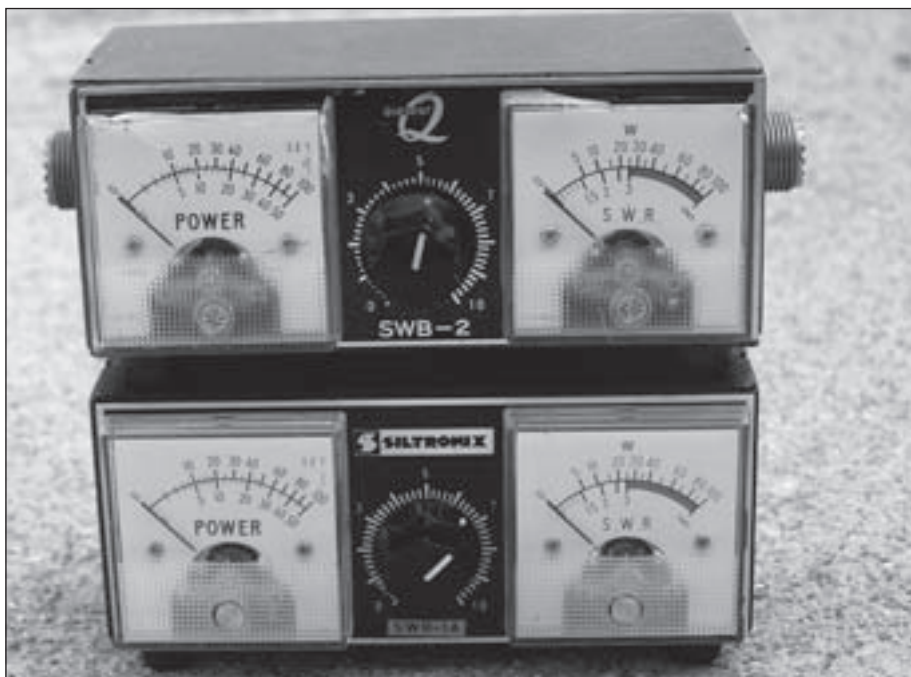
Foto B. Dos versiones del mismo medidor de ROE. El de arriba ha sufrido peor trato que el de abajo, pero una vez limpio y repasado funciona tan bien como el otro.
