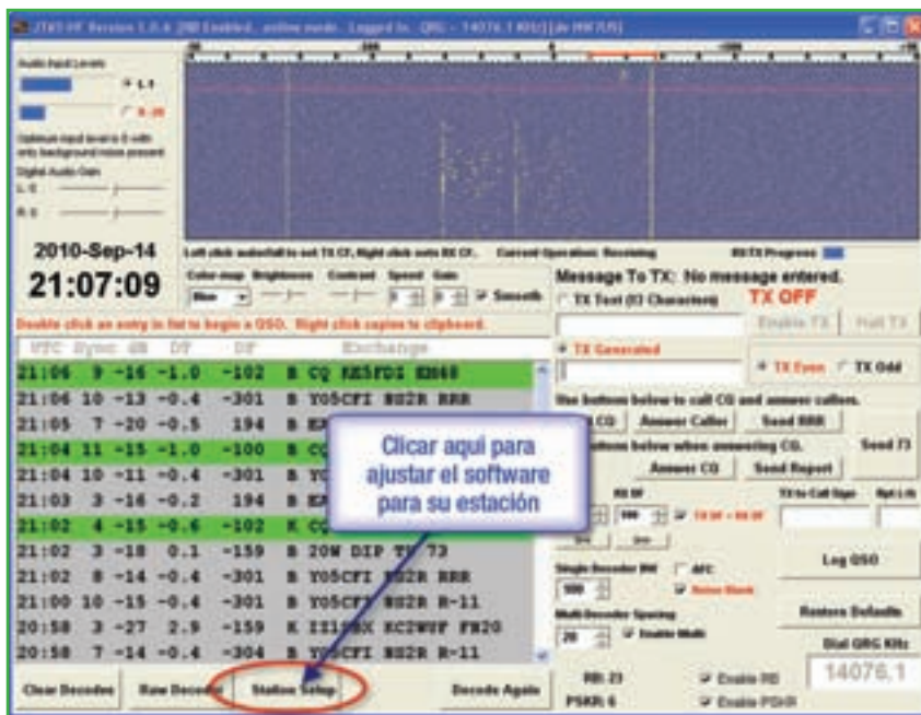
Figura 1. En cuanto se haya instalado el software JT65-HF, arrancarlo y clicar en la zona indicada para iniciar la rutina de puesta a punto. Ver más en el texto. (Todas las imágenes son de NW7US, usando el software JT65-HF)
