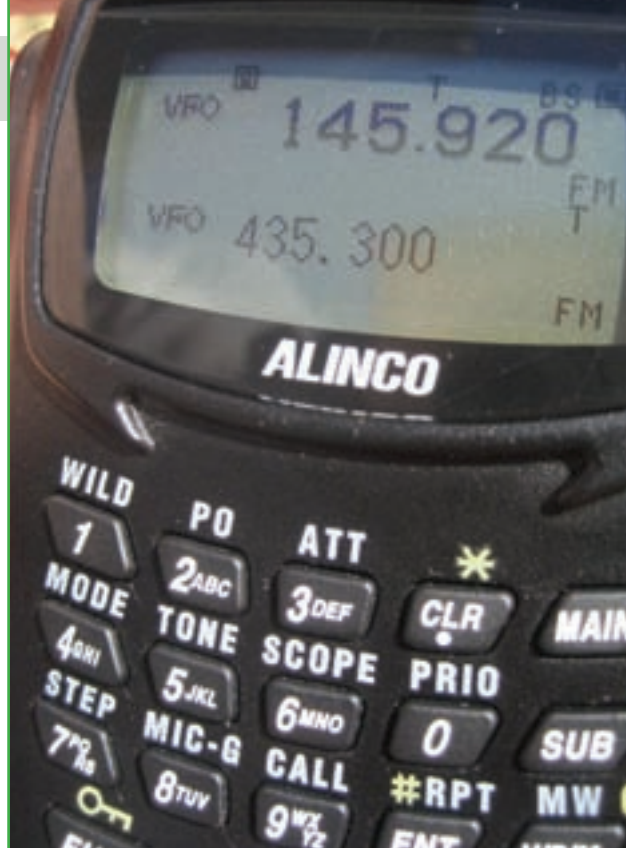
Foto C. La pantalla LCD muestra el equipo operando con una de las memorias duales, configurada para operar en dúplex mediante el satélite de FM A0-51.
