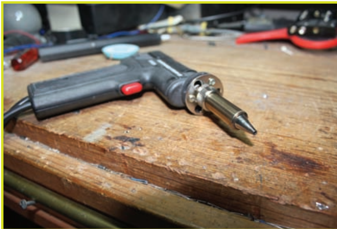
Foto C - La herramienta de desoldar Aoyue 474+ con su bomba de vacío.
