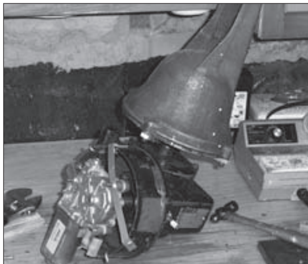
Foto B. Mi super-rotor de construcción casera utiliza un potente motor de elevadoras de coche y una carcasa de un viejo rotor para soportar el mástil y un potente reductor de tornillo sinfín. Utilizo la placa Arduino Uno para controlar el motor y detectar la dirección a la que apunta la antena.
