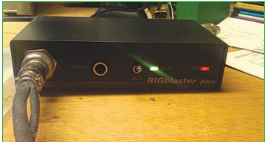
Foto 3. Quienes operen en radiopaquete con una tarjeta de sonido y software de TNC, tan sólo necesitarán adicionalmente (aparte de una estación de 2 metros para FM) un interfaz entre equipo de radio y ordenador, como el RigBlaster de West Mountain Radio.
