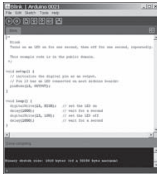
Figura 2. La rutina (Sketch) llamada "Blink" (encender brevemente) hace que se encienda el LED conectado a la patilla 13 de la placa una vez cada segundo (cada 1000 milisegundos). Muchos ejemplos de rutinas (Sketches) junto con muchas fuentes de recursos facilitan la tarea de aprender a programar una placa Arduino.
