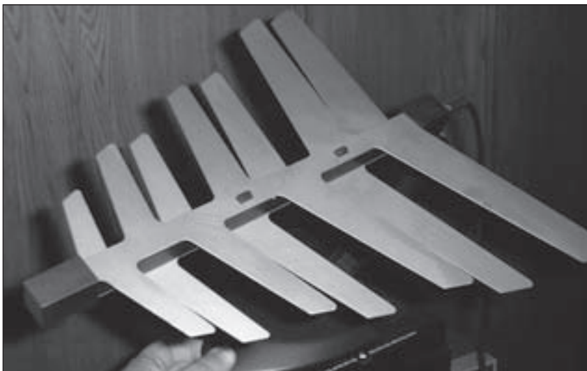
Foto B. Elementos de la logarítmica debidamente enfasados
