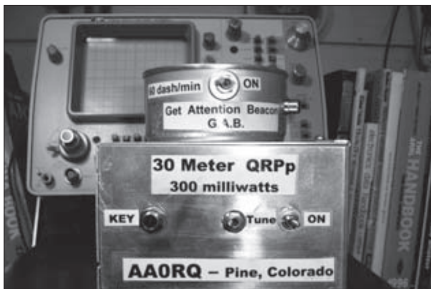
Foto B. El equipo de Bill, AA0RQ, saca 300 mW en la banda de 30 metros y dispone de un accesorio GAB, que es exactamente una baliza para llamar la atención.
