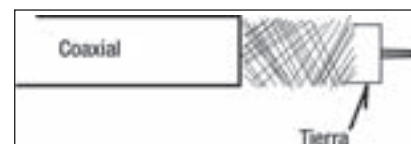
Figura 3. Cable coaxial de tierra
