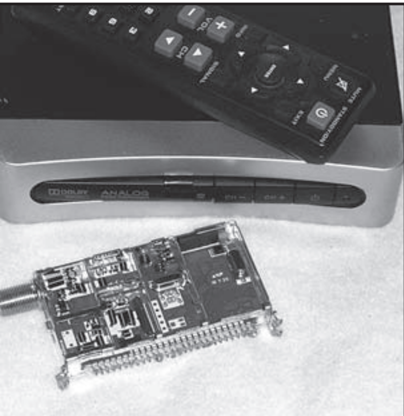
Foto A. Un convertidor de 40 dólares para recibir la TV digital
