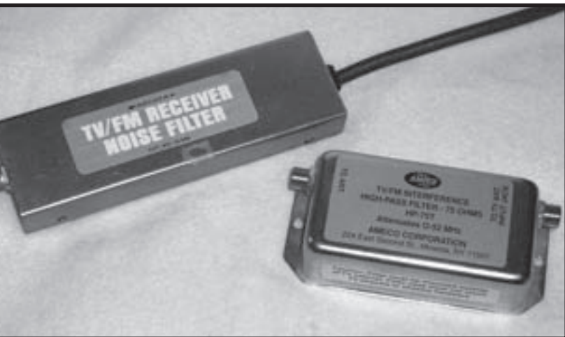
Foto B. Un filtro de TV paso alto con 52 MHz de frecuencia de corte
