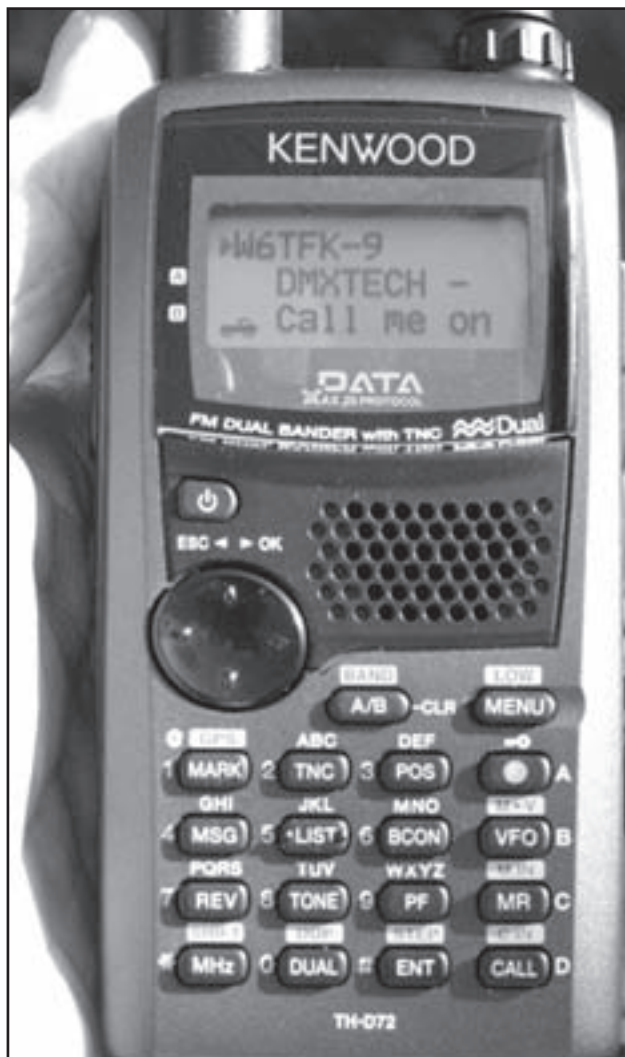
Foto A. El TH-D72A dispone de un receptor GPS y una TNC con programas para operar APRS también.
