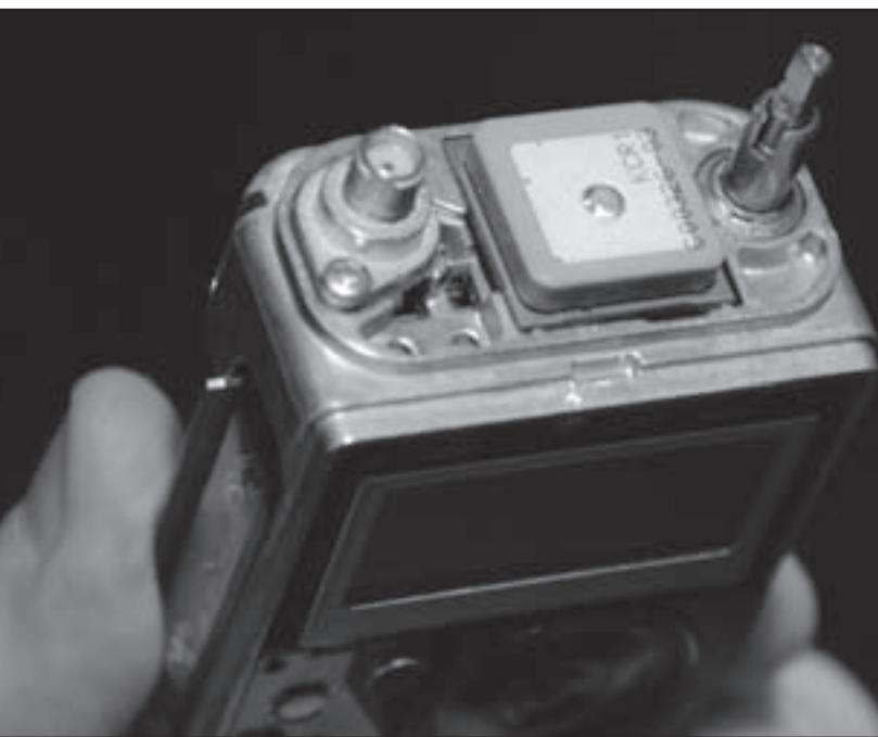
Foto E. El conector de antena del TH-D72 dispone de contactos plateados para sustituirlo sin soldadura si fuera necesario. Léete las "Prestaciones ocultas" (foto cedida por W6GPS).
