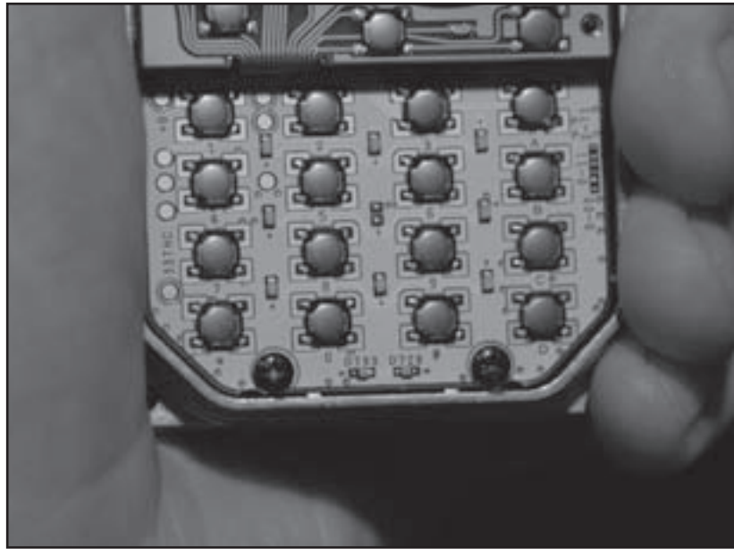
Foto F. El teclado del D-72 se puede reemplazar fácilmente si se estropea. Es muy fácil extraer el viejo y encajar uno nuevo.
