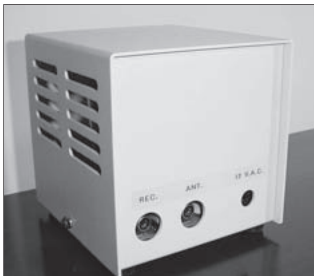
Foto F. Vista de la parte posterior del transmisor Glowbug 40.
