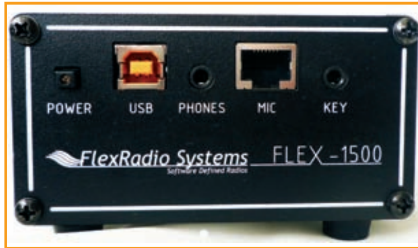
Foto B. Panel frontal del Flex-1500 en el que se pueden ver de izquierda a derecha el pulsador de puesta en marcha, el conector de micrófono RJ-45, el mini-jack estéreo para los auriculares y el mini-jack estéreo para el manipulador, ya sea vertical o de palas laterales.
