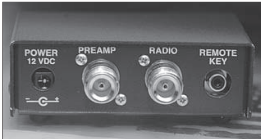
Esta es la parte posterior de la caja de control del preamplificador Mirage. Observa que recibe la tensión de 12 V y la introduce en el vivo del cable coaxial que va al preamplificador del mástil para alimentarlo. Simple, sencillo y limpio.
