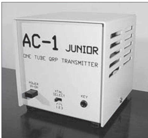
Foto D. Panel frontal del transmisor de CW Glowbug para 40 m (fotos de los Glowbug cedidas por Dwight Morrison, KG4HSY).
