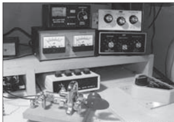
Foto D. Este son los acopladores y el conmutador de la estación K7SZ. El de encima es un acoplador MFJ-901 que sintoniza la antena circular, mientras que el de abajo es el modelo MFJ-901B que controla la EDZ para 40 metros. El conmutador de antena de la derecha me permite escoger entre la antena circular, la EDZ y la vertical MFJ para 40/80 metros.
