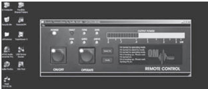
Así es como aparece el amplificador remoto en la pantalla del ordenador. Con la tecnología HTTP, puedes controlar cada función con el ratón, ver la potencia de salida real y monitorizar el estado de los LED, además de recibir un stream de mensajes sobre el funcionamiento del amplificador. No necesitas preocuparte de que el amplificador remoto cause ruido o interferencias.
