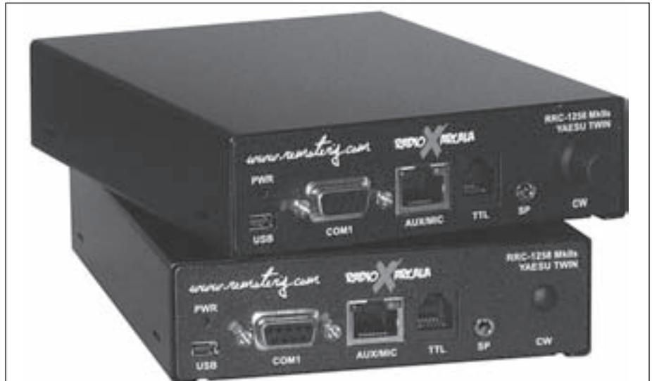
Las unidades de control remoto RRC utilizan tres canales de comunicación: un simple protocolo SIP para establecer la comunicación radio-radio, mientras que el protocolo UDP tipo datagrama se utiliza para el control y los canales de audio. Las unidades RRC proporcionan dos puertos series adicionales para conectar otros dispositivos, tales como amplificadores lineales y un rotor.
