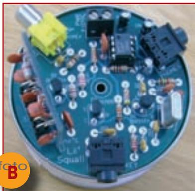
final, el cristal y los condensadores de realimentación del oscilador, y el filtro paso banda es un módulo intercambiable. Incluye un cristal para 7122 kHz, pudiendo adquirirse cuarzos para otras frecuencias por 10 dólares la unidad, o emplear otros cristales que posea el usuario. Su precio: 35 dólares; visitar el sitio web <http://www.qrpme.com>.
