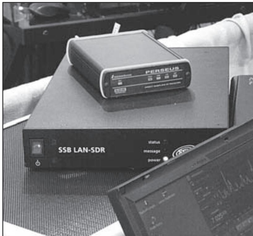
Foto E. SSB Electronic de Alemania presenta el nuevo receptor SSB-LAN SDR (Radio definida por Software), que puede operar con un ordenador en cualquier lugar de tu red WiFi hogareña, así como también un software actualizado del Perseus para que hacer lo mismo.
