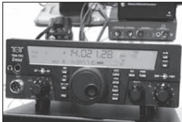
Foto C. The Eagle es el nuevo transceptor de HF+6 m de Ten-Tec, un gran equipo en una pequeña caja
