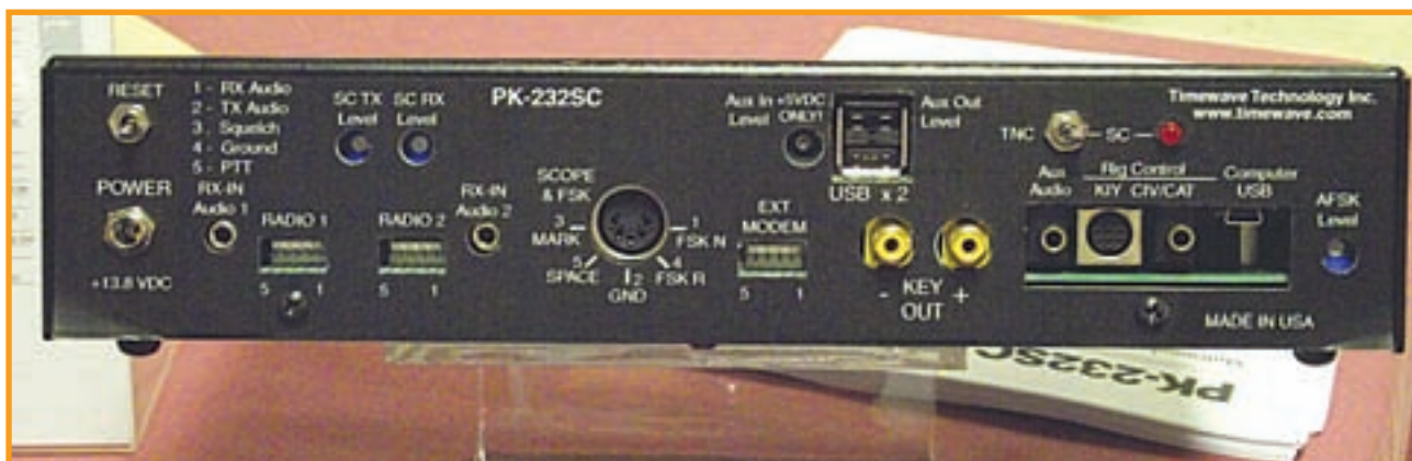
Foto J. El panel posterior del PK-232SC de Timewave Technologies, toda una interface digital. Observa los dos puertos USB. Además, contiene un distribuidor de 4 puertos USB (hub) en su interior.
