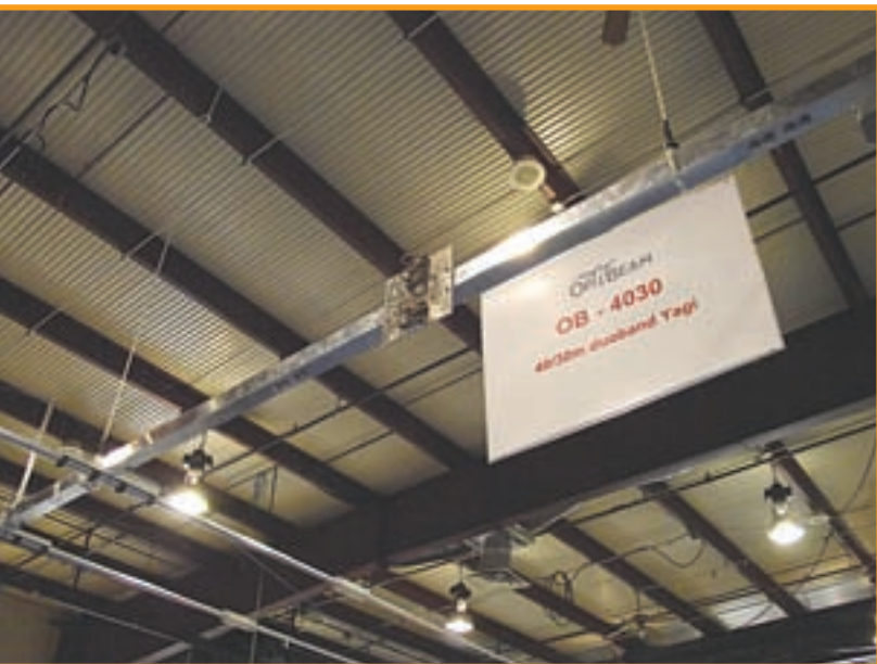
Foto O. La antena directiva Opti-Beam 4030 es una gigantesca Yagi bibanda que cubre los 40 y los 30 metros.
