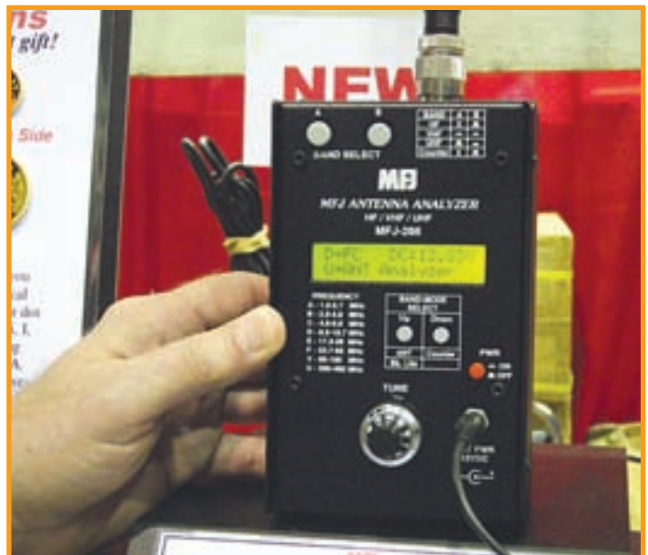
Foto C. El MFJ-266 es un analizador de antena que cubre HF, VHF y UHF y puede medir al mismo tiempo la ROE, la impedancia y la reactancia inductiva o capacitiva.
