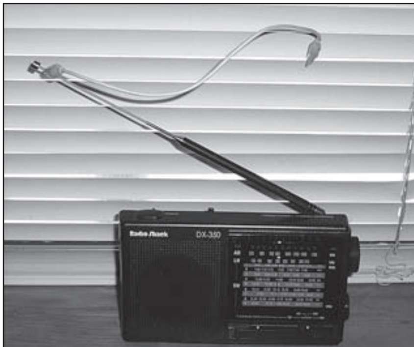
Foto A. Más sencillo y eficaz (a pesar de su ROE, ver texto), imposible: antena para escucha de onda corta.
