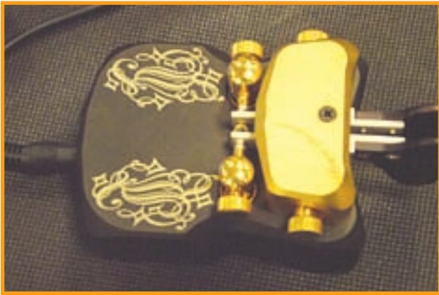
Foto L. El manipulador Stradivarius de Begall Keys está modelado sobre un bloque de titanio. No se deslizará en absoluto por encima de tu mesa de trabajo.
