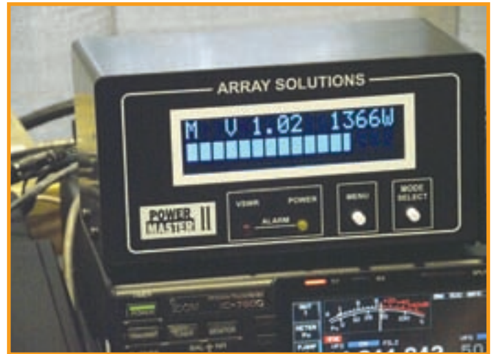
Foto N. Array Solutions presentó su medidor de potencia Power Master II, un medidor de ROE/potencia que soporta dos captadores de RF y una lectura realmente cómoda.
