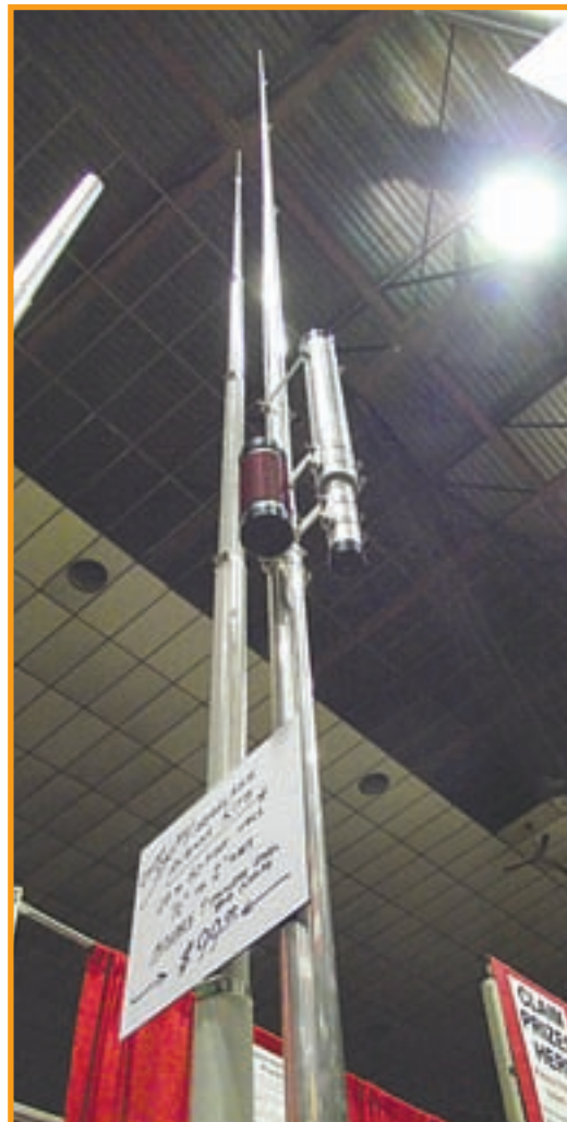
Foto B. La vertical de DX Engineering Thunderbolt, una vertical de 16 metros monobanda para 75/80 metros.
