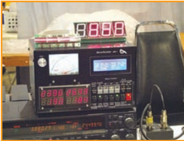
Foto Q. El kit del MB-1 de Meter Builder es uno de los productos más curiosos que vimos en Dayton. Dispone de display tanto analógico como digital y muestrea 500 datos por segundo.
