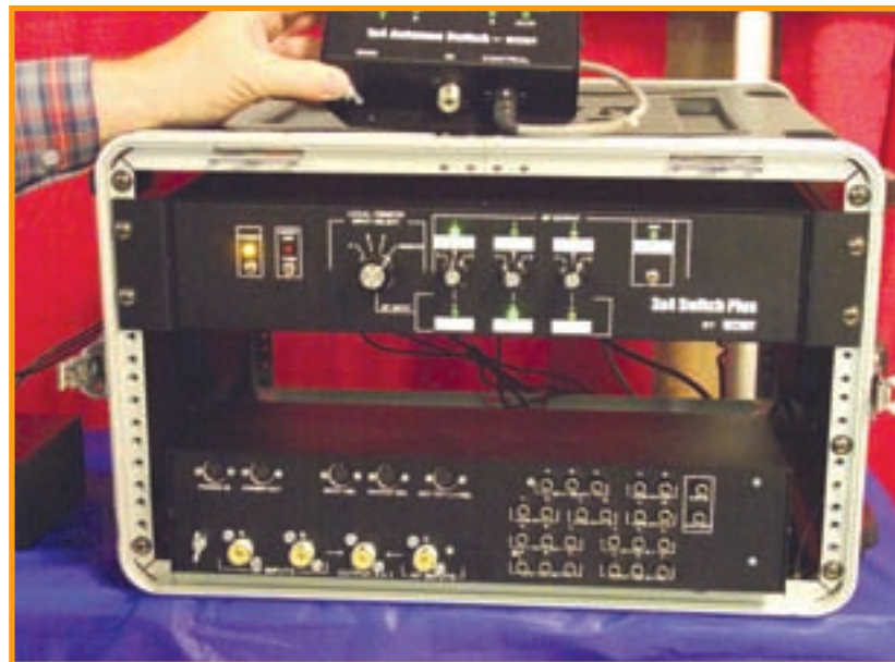
Foto H. El conmutador coaxial 3x4 Switch Plus (en un rack) procede de W2IHY Technologies y permite conmutar tres equipos y cuatro antenas.
