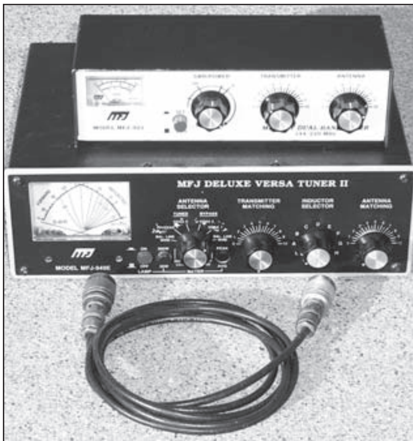
Foto D. La mayoría de adaptadores de antena no serán capaces de adaptar cualquier antena a cualquier frecuencia.
