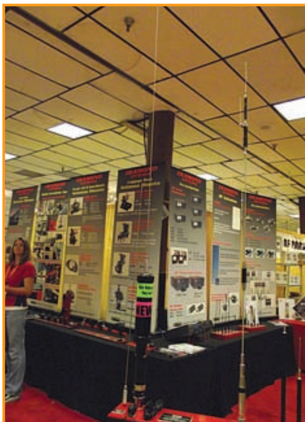
Foto K. La nueva antena SD330 de Diamond Antennas es del tipo sintonizable por tornillo bisinfín y cubre de 80 a 10 metros.
