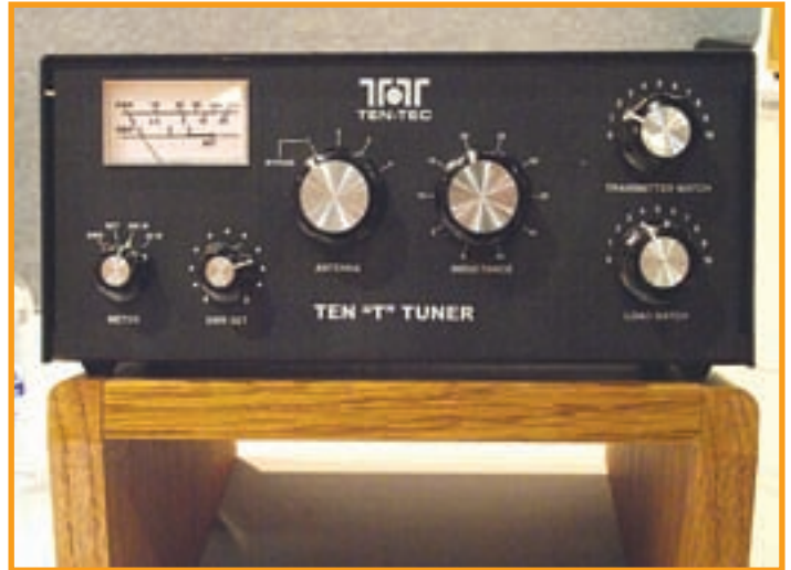
Foto M. El acoplador Ten "T" Tuner de Ten-Tec tiene el aspecto y el tacto muy resistentes de los acopladores clásicos. Pero siempre hay algunas desadaptaciones que ni el mejor acoplador del mundo puede resolver.
