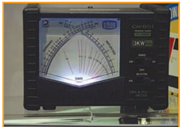
Foto F. El medidor de potencia Daiwa CN-801HP3 que soporta hasta 3000 vatios.
