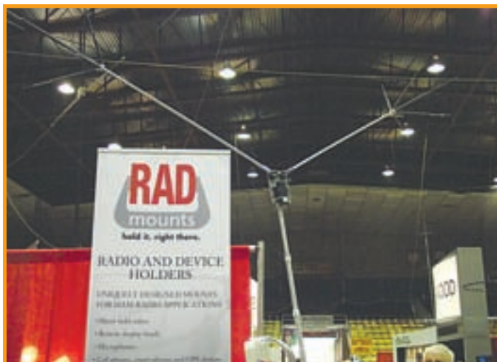
Foto E. La nueva antena Comet CHV-5X es un dipolo giratorio para utilizar en móvil o en portable. Cubre de los 40 a los 6 metros y puede ser configurada de varias maneras.
