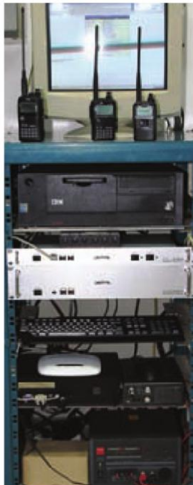
Repetidor DStar. Sobre él los portátiles IC-E92, IC-E91 y el nuevo ID-31
