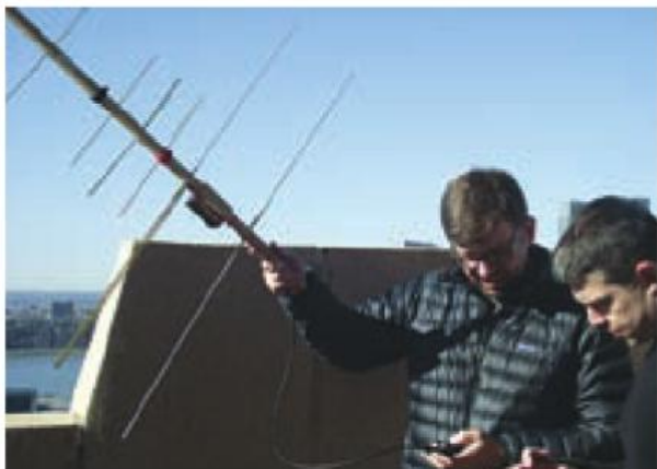
Un portátil y una antena direccional portátil es todo lo que necesitas para operar en algunos satélites en FM. Esta antena es una "Cheap Yagi" de construcción casera, diseñada por el Editor de Antenas de CQ, Kent Britain, WA5VJB. Aquí están Dave Clausen, W2VV, y Bill Ward, KD4ISE, intentando trabajar el SO-50 desde la terraza de un hotel en Nueva York. Observa el ángulo de la antena como se describe en el texto (Foto cedida por W2VU).
