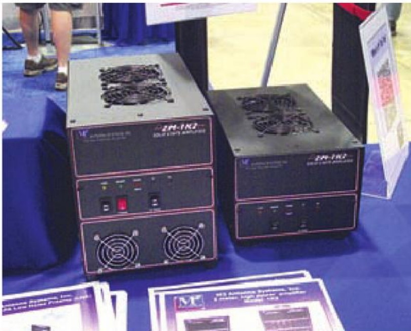
Foto H. Amplificador 2M-1K2 de M2 Antennas para 144 MHz.
