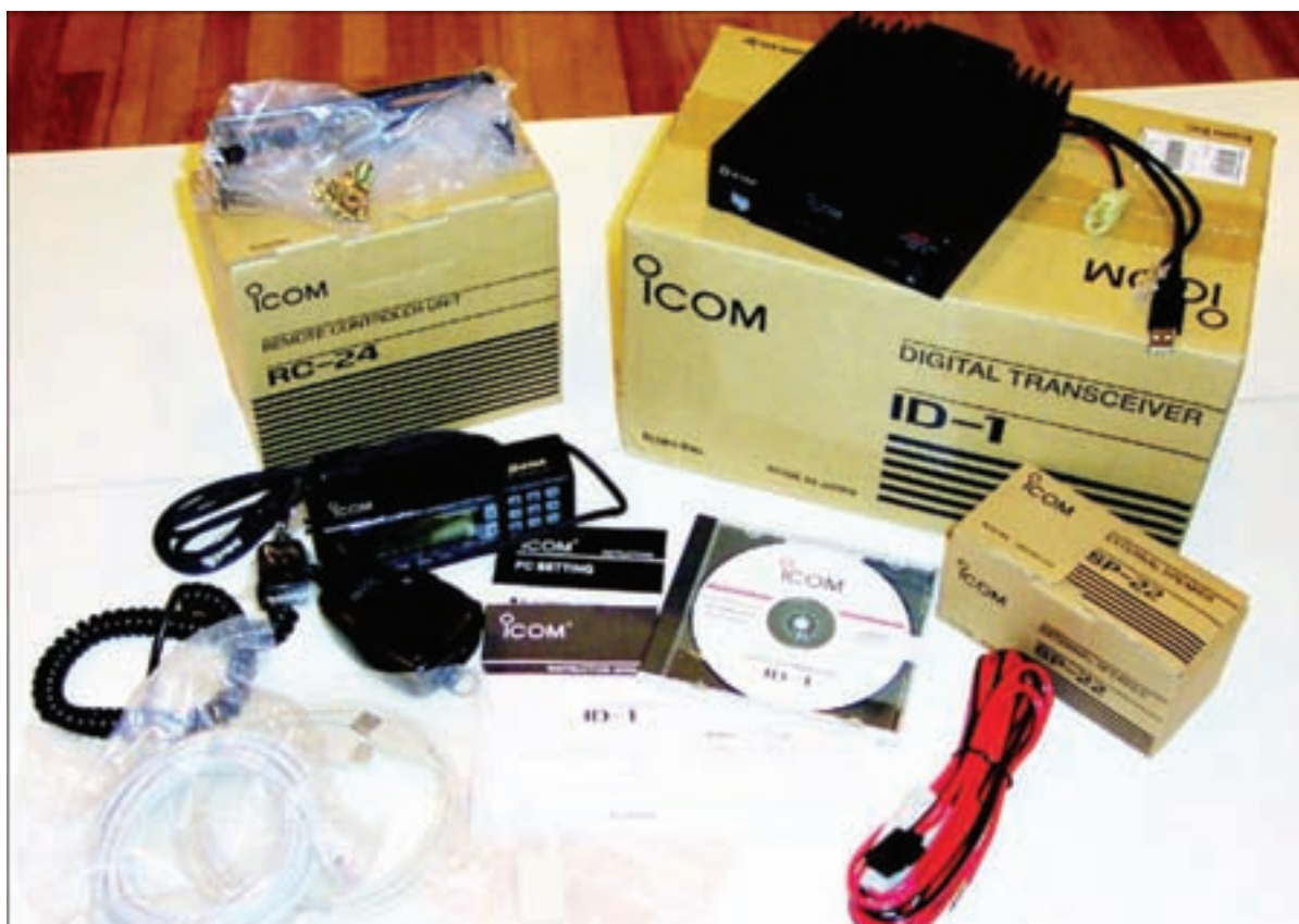
Fig. 2: Mi equipo transceptor ID-1 de ICOM con D-STAR el día que salió de la caja. Ha tenido unas pocas horas de uso desde entonces. Cuando abres la caja de un transceptor ICOM ID-1 encuentras algo inesperado, en concreto unos cables USB y Ethernet y un CD para programar el equipo.
