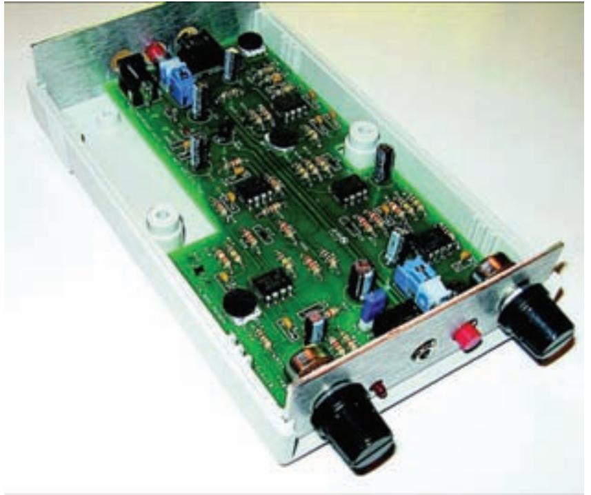
Foto D: El filtro de CW Scrubber listo para limpiar las señales débiles de CW (Foto cedida por WD9F)
