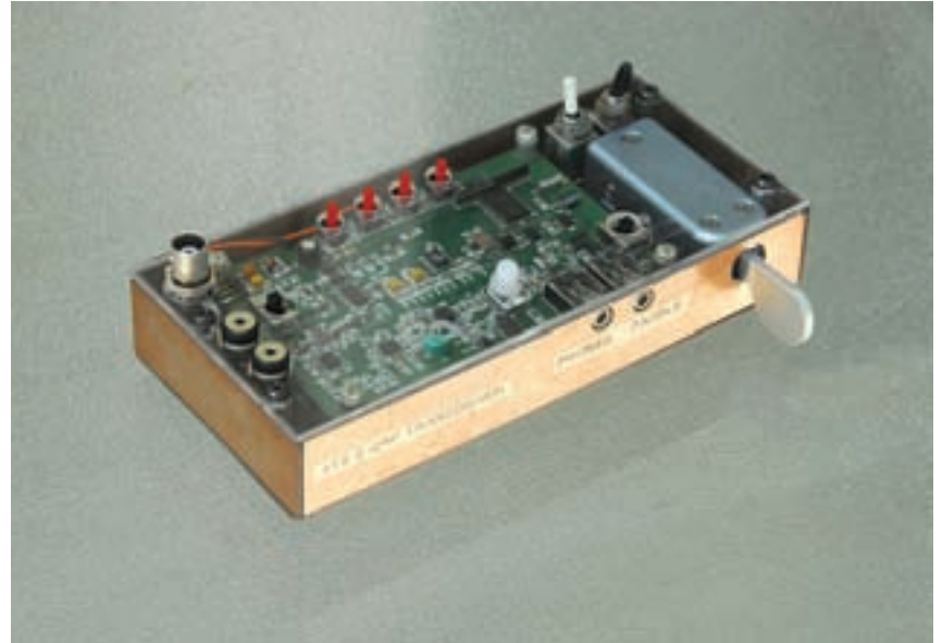
Foto A. El QRP ATS-2 construido y empaquetado por Steve Russell, N7SR. El montaje diseñado por Steve incluye la caja, la placa del transceptor, un manipulador de palas y la batería.
